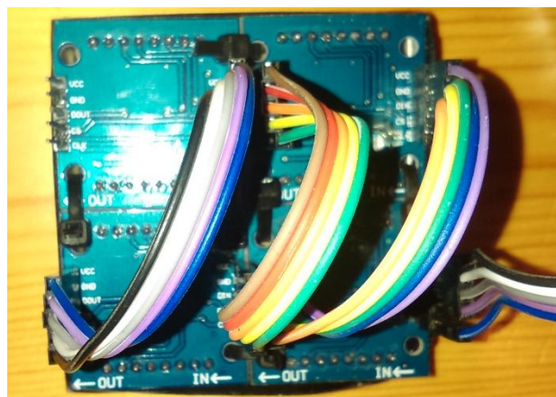
Slika 4.9. Međusobno povezivanje više modula
