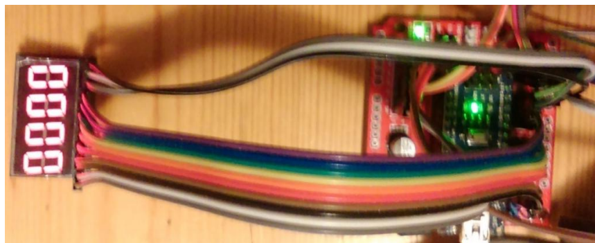
Slika 4.7. Spoj sedam segmentnog pokazivača i Arduina
