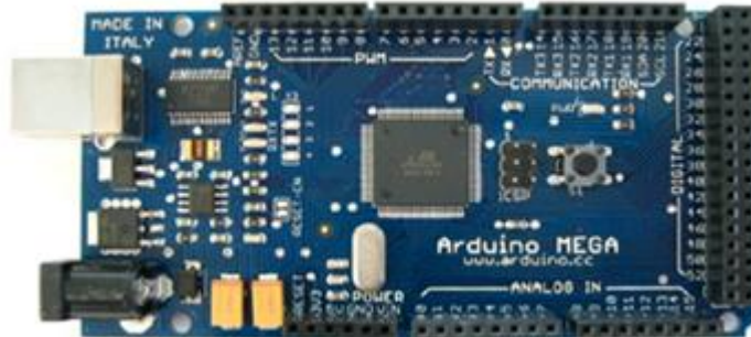
Sl. 3.1. Arduino Mega 2560 (A2, A7).
