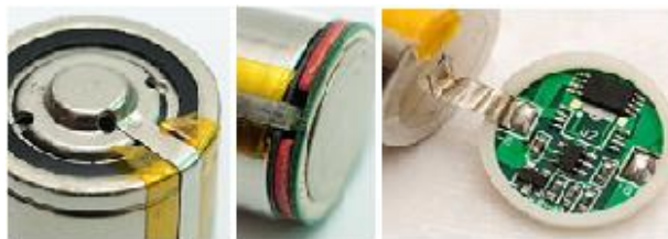
Sl. 3.26. Prikaz zaštitne elektronike.
