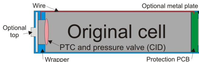
Sl. 3.24. prikaz konstrukcije 18650 baterije. [Izvor: http://www.lygte-info.dk/info/battery%20protection%20UK.html ]
