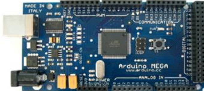
Sl. 3.1. Arduino Mega 2560 (A2, A7).
