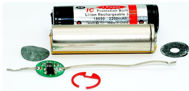
Sl. 3.25. prikaz konstrukcije 18650 baterije. [Izvor: http://www.lygte-info.dk/info/battery%20protection%20UK.html ]
