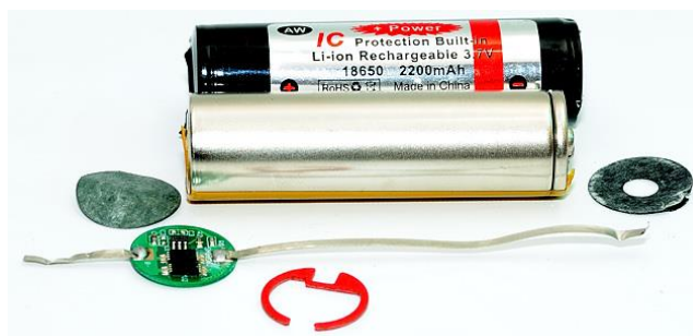
Sl. 3.25. prikaz konstrukcije 18650 baterije. [Izvor: http://www.lygte-info.dk/info/battery%20protection%20UK.html ]
