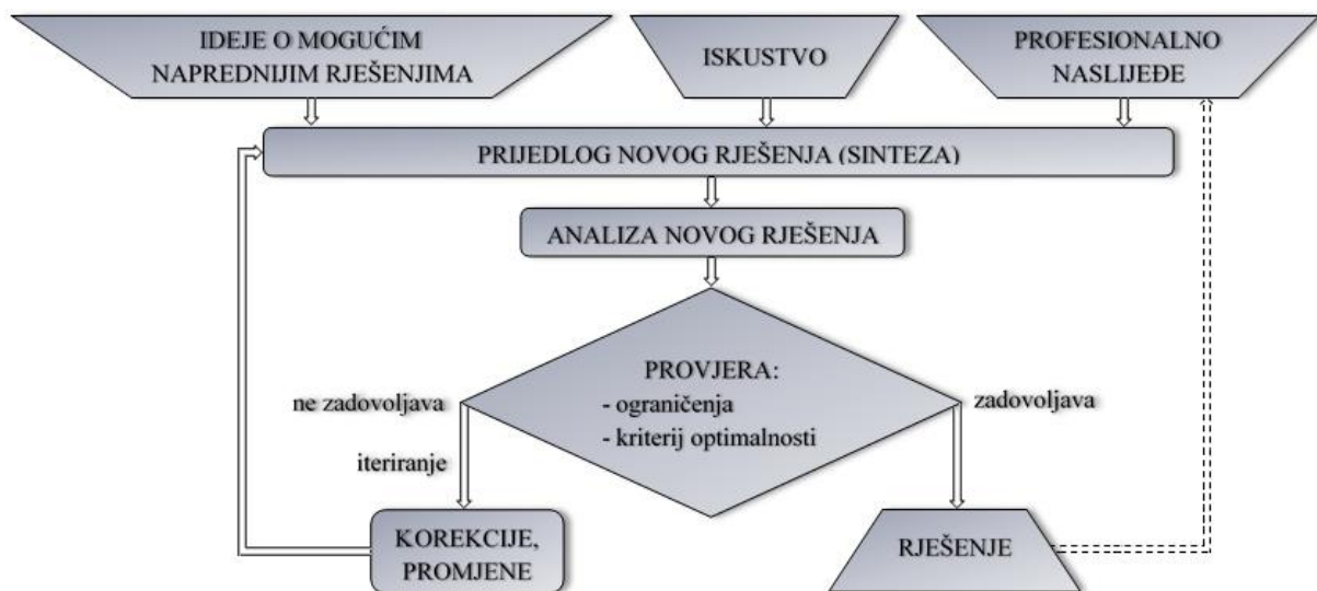
Slika 3.2. Opći prikaz optimizacijskog procesa
