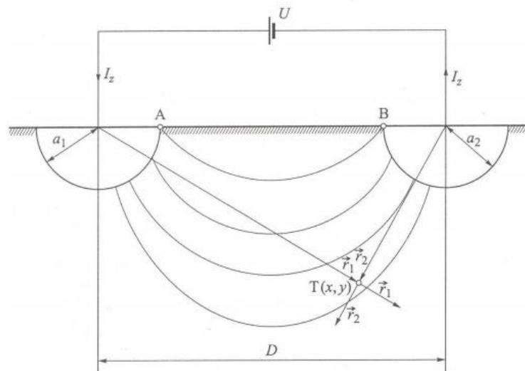
*Slika 2.7. Dva polukuglasta uzemljivača položena na površini zemlje [1]*
