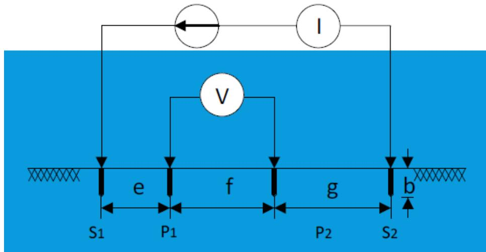
*Slika 3.4. Shema opće metode mjerjenja otpornosti tla [3]*
