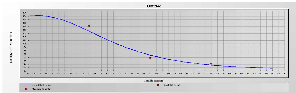
**Slika 5.6.** Grafički prikaz analize dvoslojnog modela tla trećeg mjerjenja
