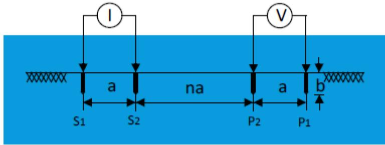
*Slika 3.6. Shema za Dipol-Dipol metodu mjerjenja specifičnog otpora tla [3]*
