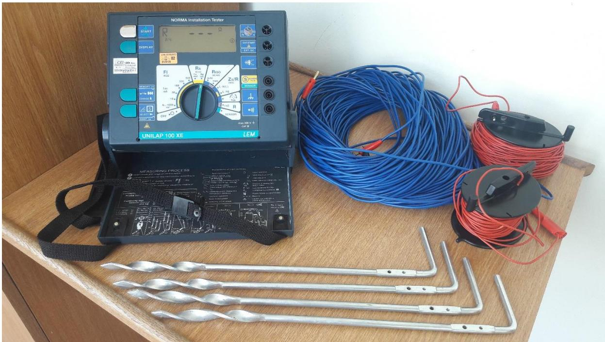
Slika 4.1. Mjerni instrument UNILAP 100 XE
