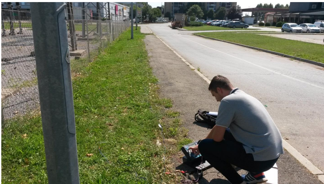
Slika 4.3. Mjerenje otpornosti tla uz trafostanicu Osijek 3
