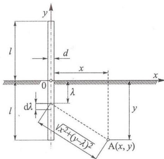
*Slika 2.9. Položaj štapnog uzemljivača za određivanje otpora uzemljenja [1]*
