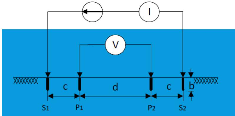
*Slika 3.3. Shema Schlumberger-ova metode mjerena otpornosti tla [3]*
