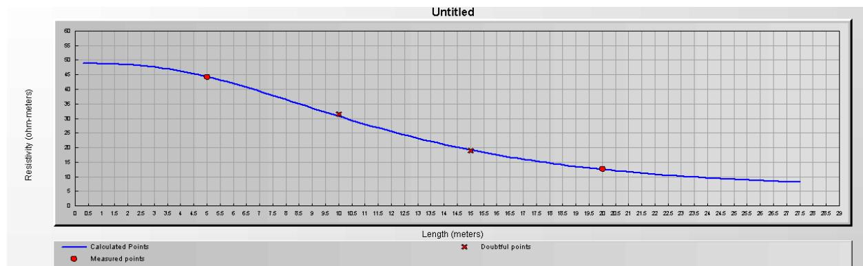
Slika 5.7. Grafički prikaz analize dvoslojnog modela tla četvrtog mjerjenja
