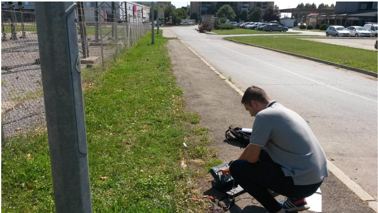
*Slika 4.3. Mjerenje otpornosti tla uz trafostanicu Osijek 3*
