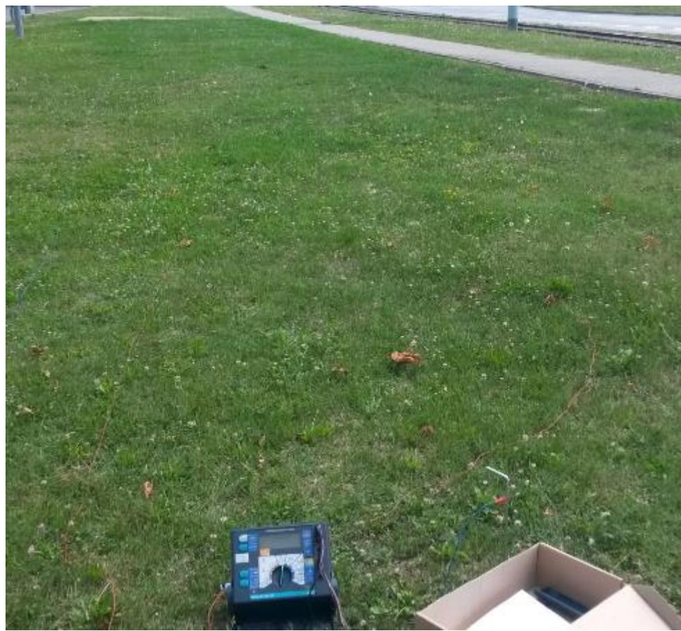
*Slika 4.5. Mjerenje otpornosti tla uz tramvajsку prugu*
