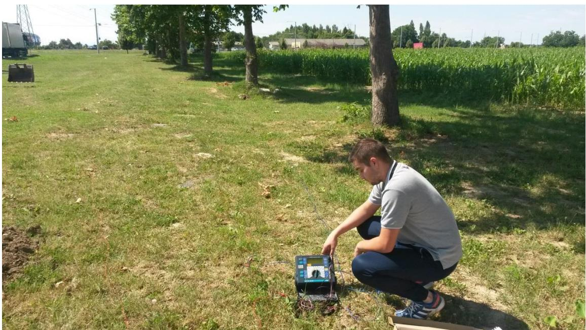
Slika 4.4. Mjerenje otpornosti tla na mekanoj zemlji
