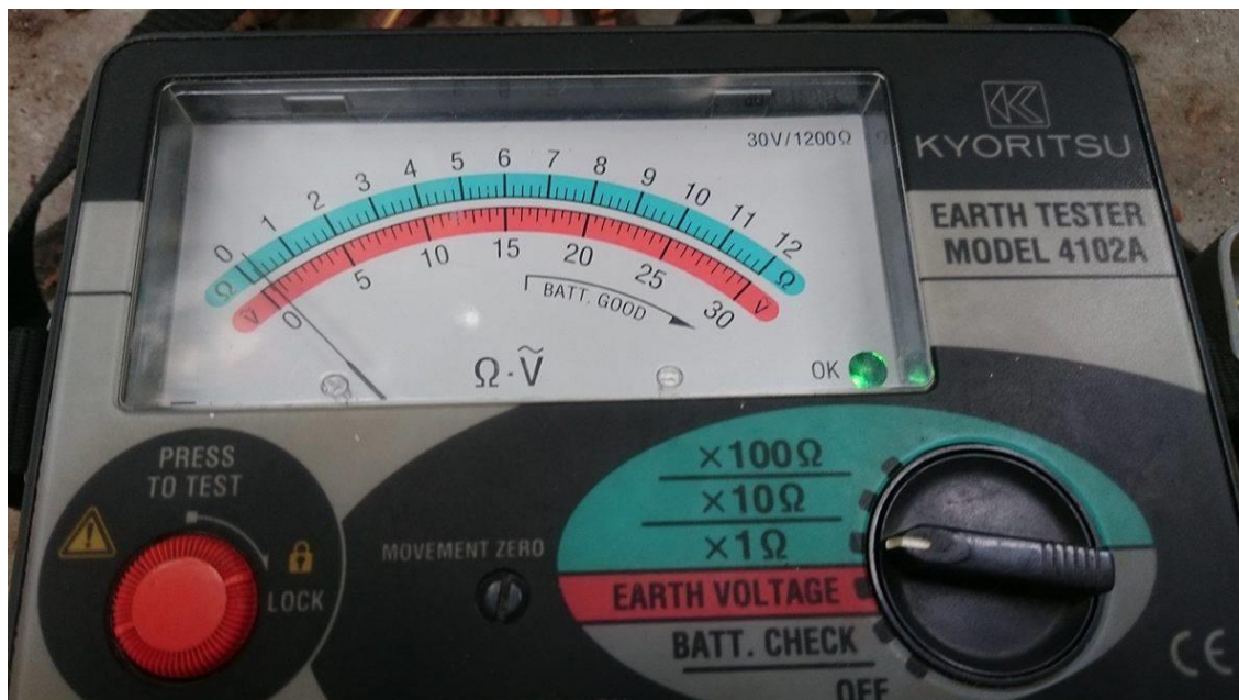
Slika 4.8. Otpor uzemljivača na zgradi FTN-a
