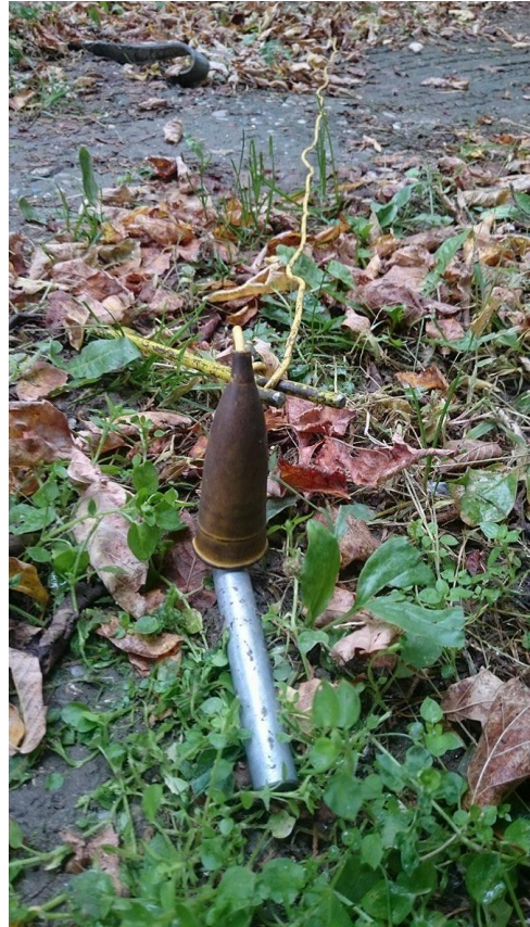
Slika 4.4. Spoj vodiča s mjernom sondom
