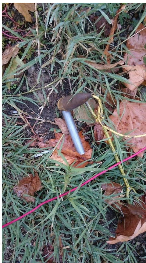
Slika 4.6. Spoj vodiča s mjernom sondom
