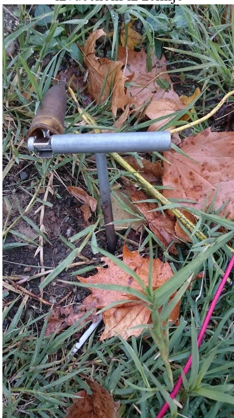
Slika 4.5. Spoj vodiča s mjernom sondom izvučenom iz zemlje
