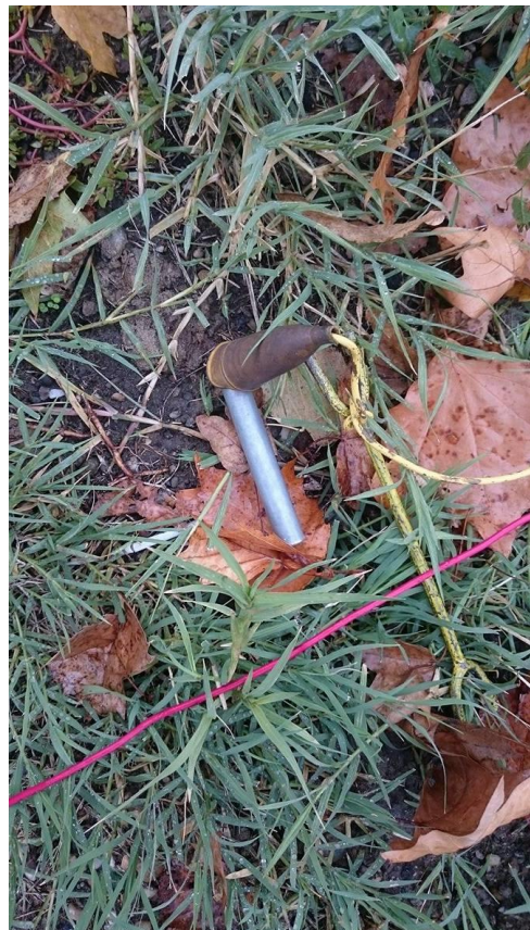
Slika 4.6. Spoj vodiča s mjernom sondom
