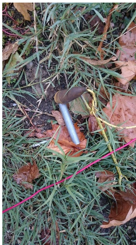
Slika 4.6. Spoj vodiča s mjernom sondom
