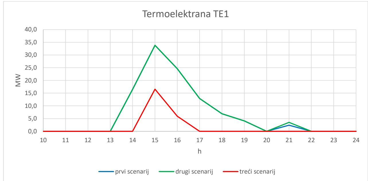
Slika 5.19. Izlazna snaga termoelektrane TE1 tijekom tri scenarija
