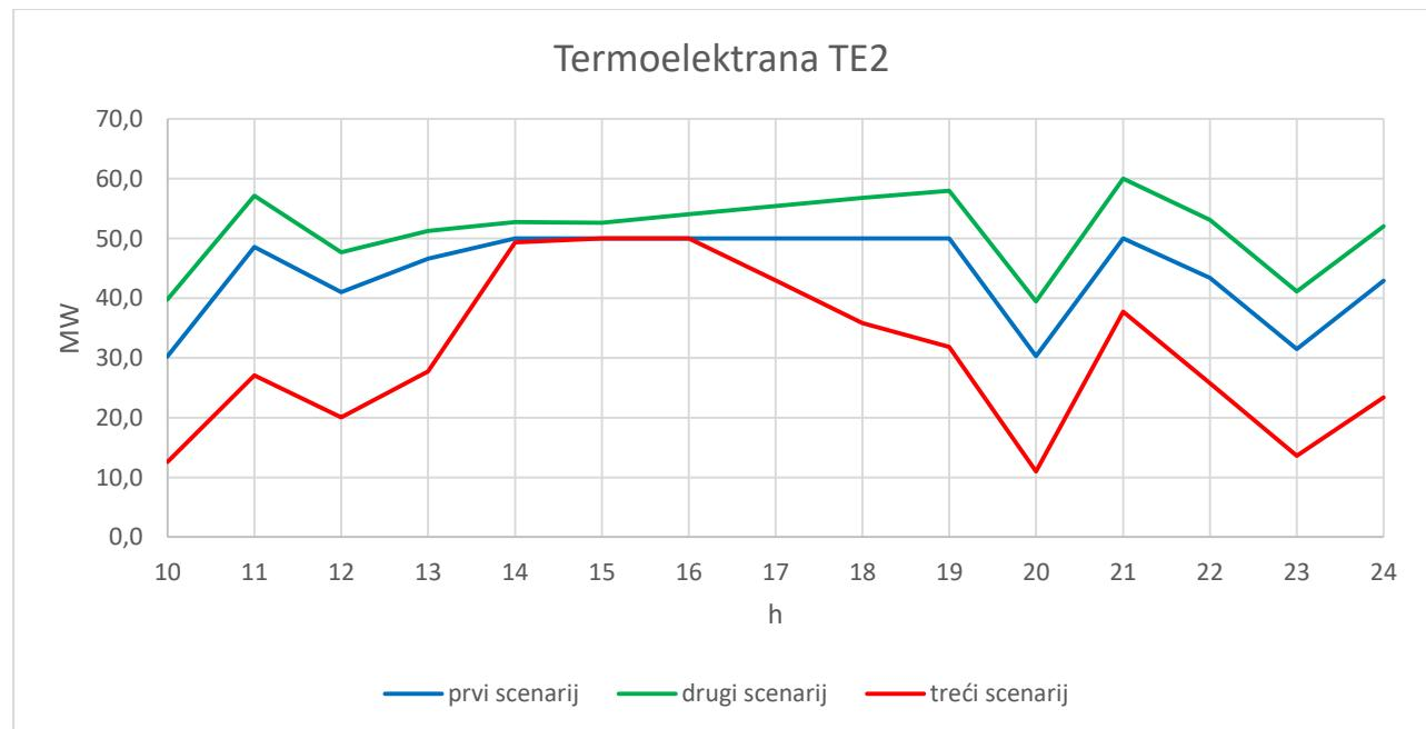
Slika 5.20. Izlazna snaga termoelektrane TE2 tijekom tri scenarija
