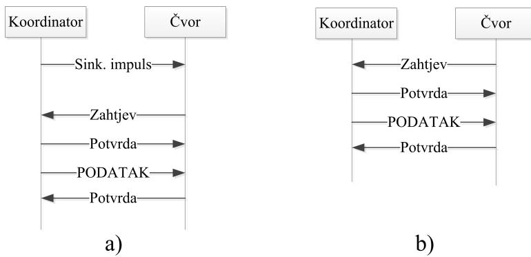
**Slika 4.8.** IEEE 802.15.4 MAC protokol u načinu rada sa sinkronizacijskim impulsom (a) i bez sinkronizacijskog impulsa (b) - vremenski slijed komunikacije
