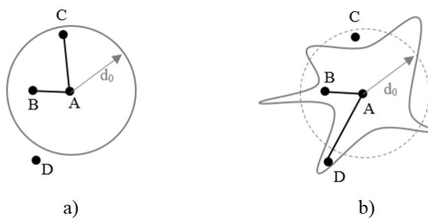
Slika 8.4. Domet komunikacije idealnog čvora a) (osnovni model propagacije) i realnog senzorskog čvora b) (Log-normalni model propagacije)
