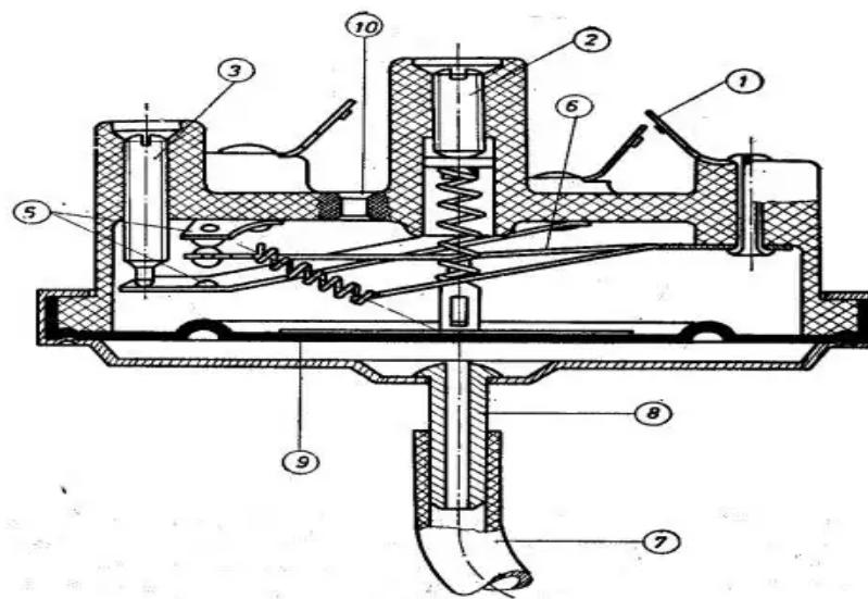
**Slika 3.26.** Presjek jednostrukog presostata.
