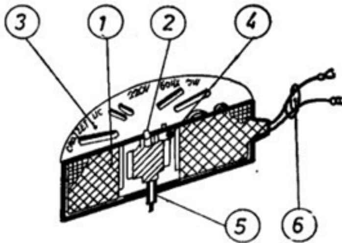
Slika 3.14. Presjek elektromotora programatora.
