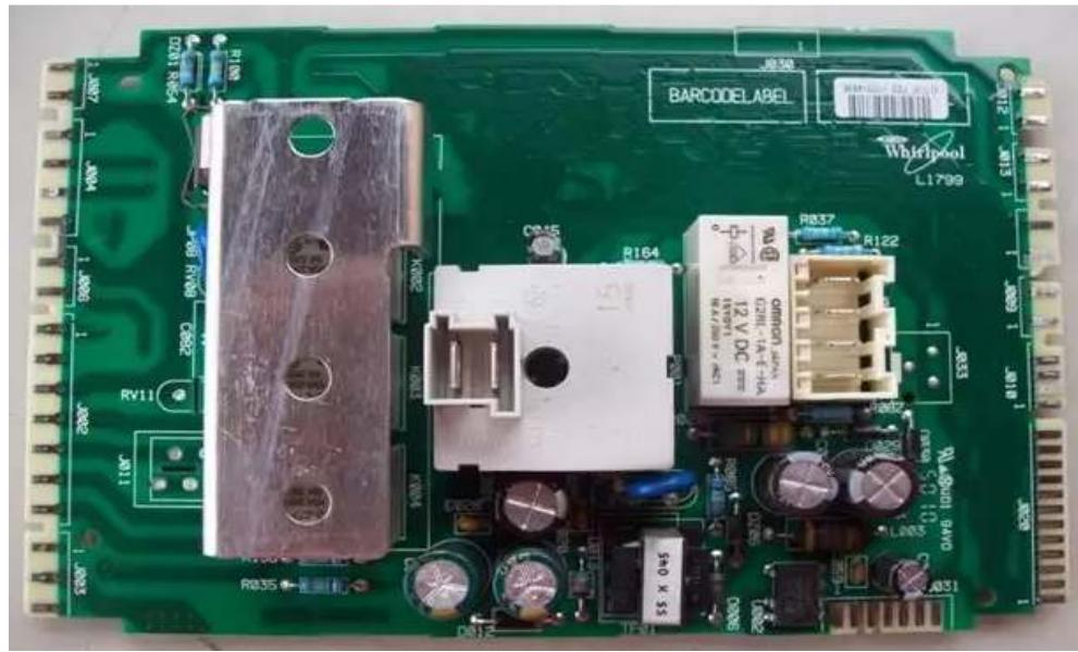
**Slika 4.2.** Elektronički dijelovi perilice rublja.
