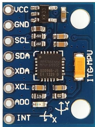
Sl. 4.6. Akcelerometar MPU-6050[19]
