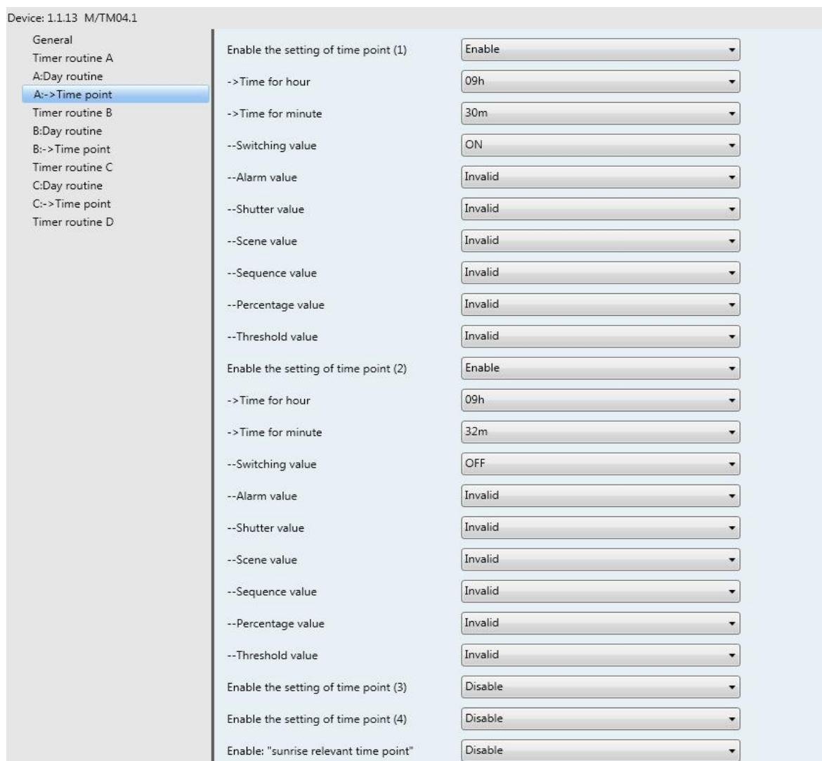
Slika 4.7. Postavljanje parametara paljenja i gašenja vremenskog aktuatora<sup>[31]</sup>
