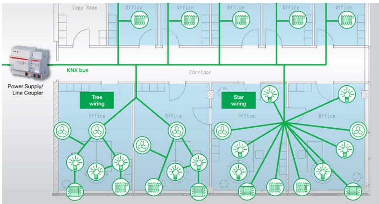
Slika 3.2. Shematski prikaz KNx instalacije u jednom objektu<sup>[14]</sup>
