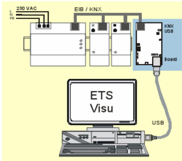
Slika 3.1. Prikaz ideje KNX instalacije i konfiguriranja preko ETS programa<sup>[13]</sup>
