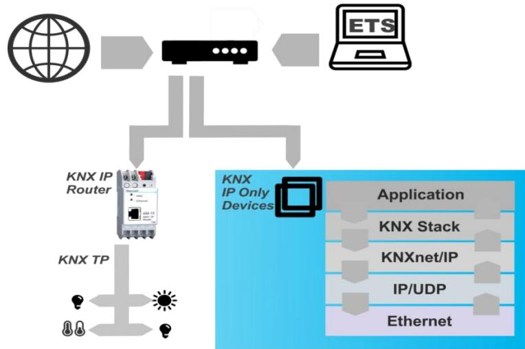
Slika 3.7. IP upravljanje sustavom<sup>[19]</sup>
