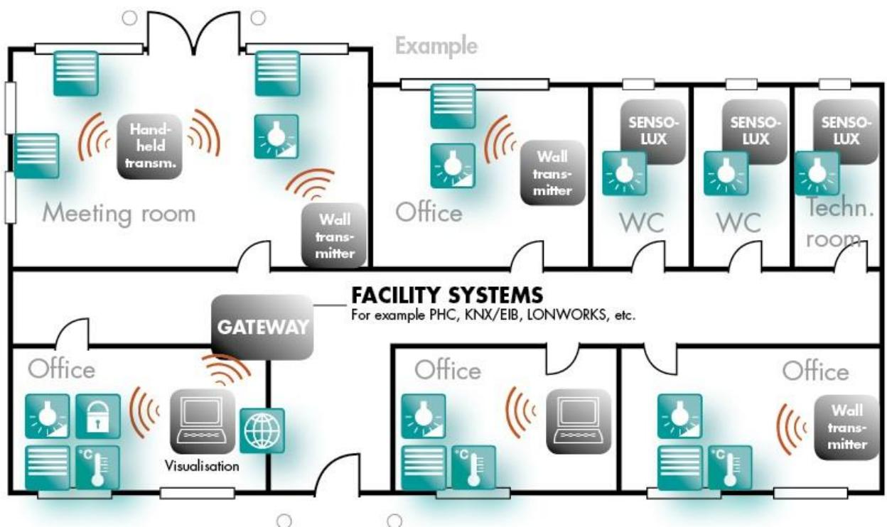
Slika 1.3. Dijelovi PHC sustava<sup>[4]</sup>
