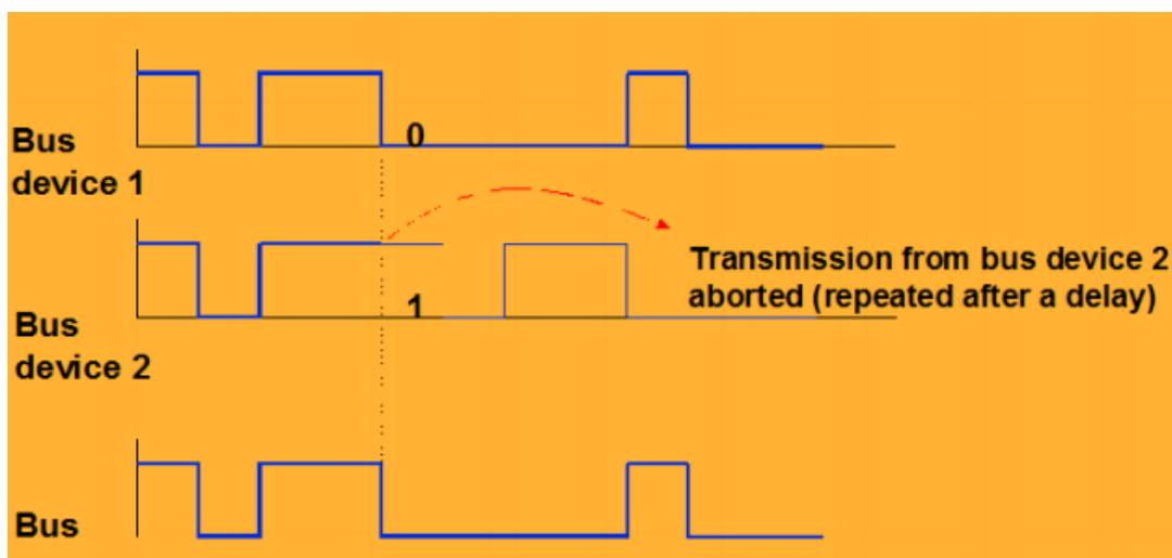
Slika 3.12. Prikaz paralelnog slanja dvaju telegrama<sup>[24]</sup>
