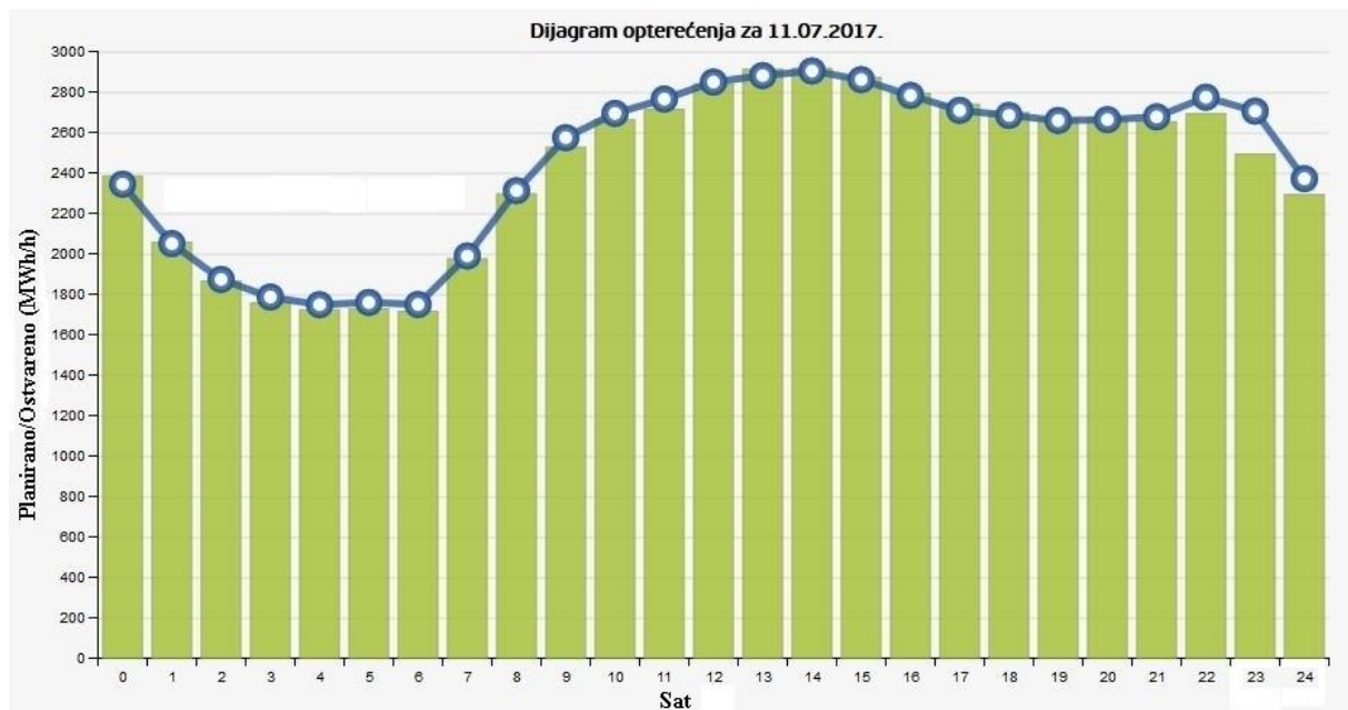
Slika 4.3. Dnevni dijagram opterećenja za Osijek, 11.07.2017 [21]
