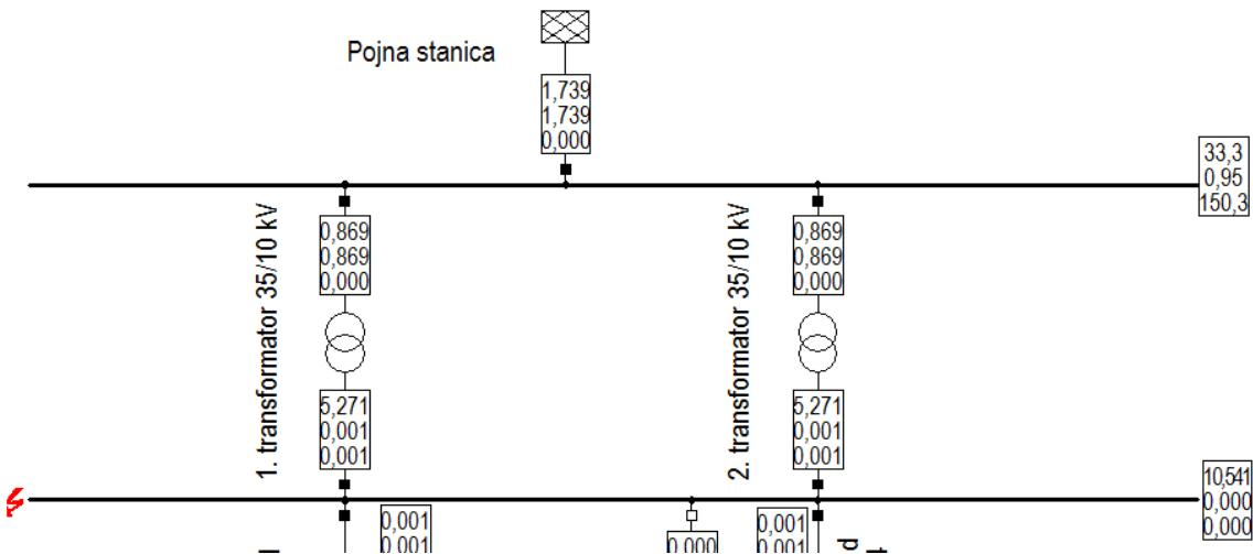
**Slika 3.18.** Jednofazni kratki spoj pri paralelnom radu transformatora
