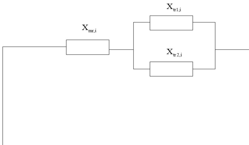
**Slika 3.23.** Shema inverznog sustava kod jednofaznog kratkog spoja
