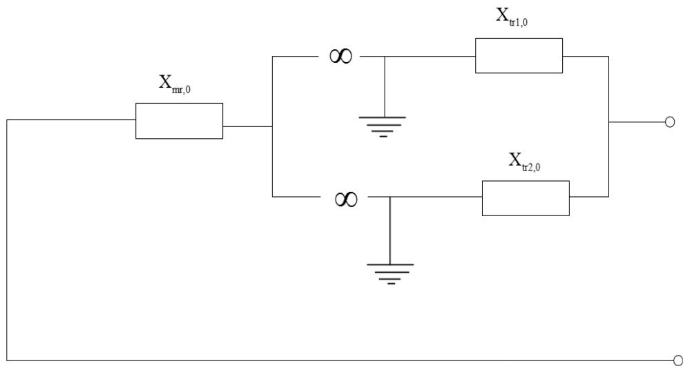
**Slika 3.24.** Shema nultog sustava kod jednofaznog kratkog spoja
