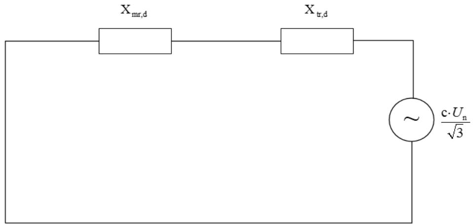
**Slika 3.25.** Shema direktnog sustava kod jednofaznog kratkog spoja (jedan transformator)
