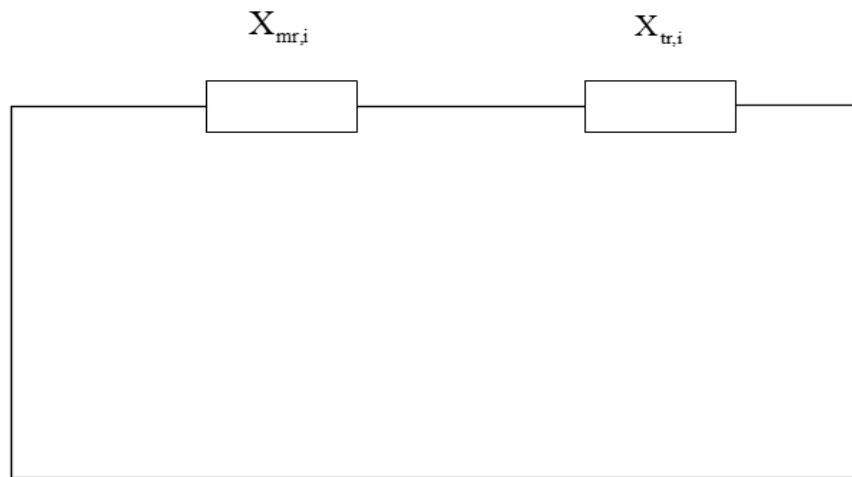
**Slika 3.26.** Shema inverznog sustava kod jednofaznog kratkog spoja (jedan transformator)
