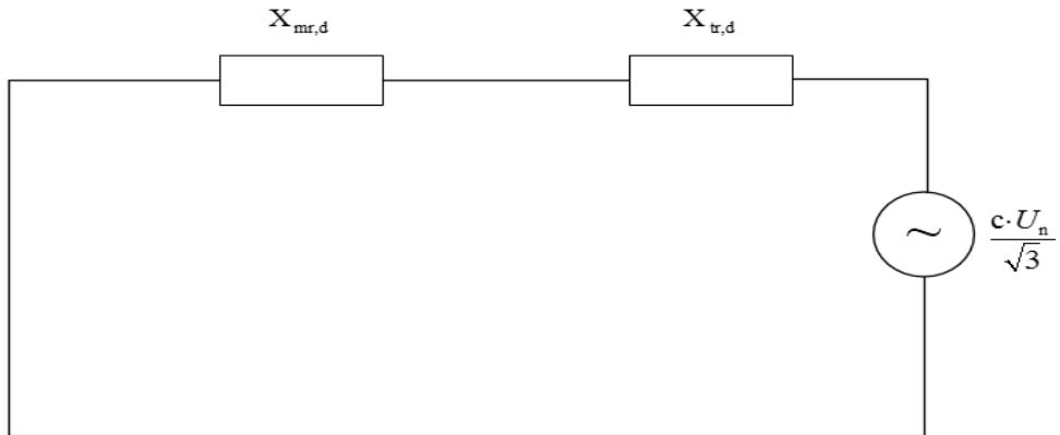
**Slika 3.22.** Shema direktnog sustava kada transformatori nisu u paralelnom radu
