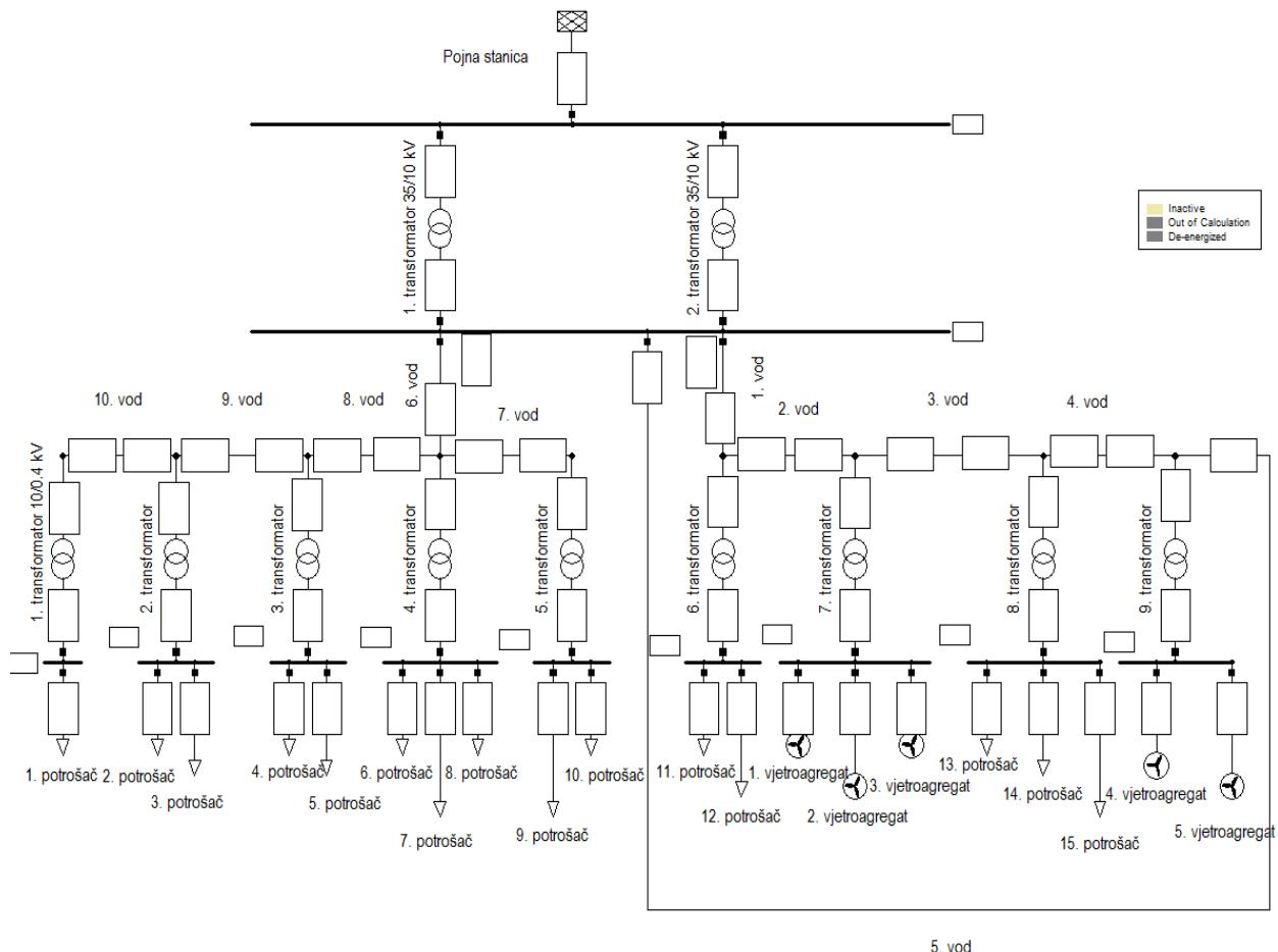
**Slika 3.5.** Jednopolna shema rasklopnog postrojenja 35/10 kV
