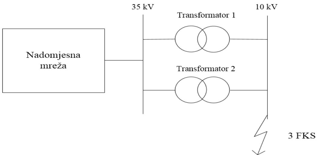
**Slika 3.20.** Shema sustava pri paralelnom radu transformatora
