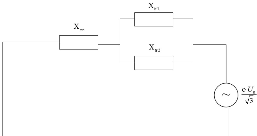
**Slika 3.21.** Shema direktnog sustava
