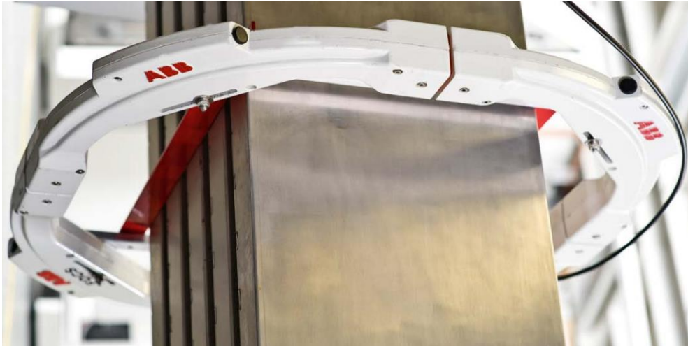
Slika 4.12 – Strujni optički senzor proizvođača ABB [11]
