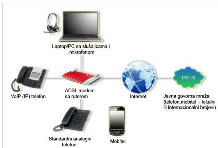
Slika 2.2. Prikaz VoIP usluge [4]
