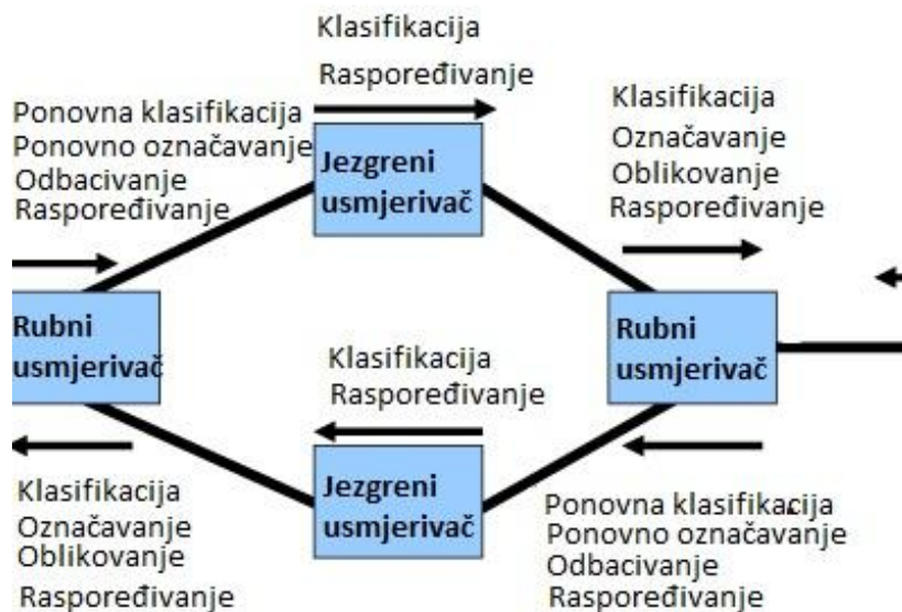
Slika 4.2.2.1. Model QoS-a na temelju diferenciranih usluga (DiffServ) [14]
