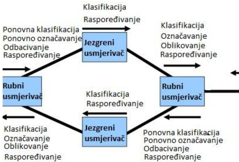
**Slika 4.2.2.1.** Model QoS-a na temelju diferenciranih usluga (DiffServ) [14]
