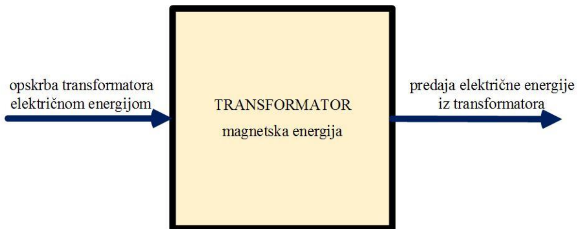
Slika 2.1. Pretvorbe energije u transformatoru
