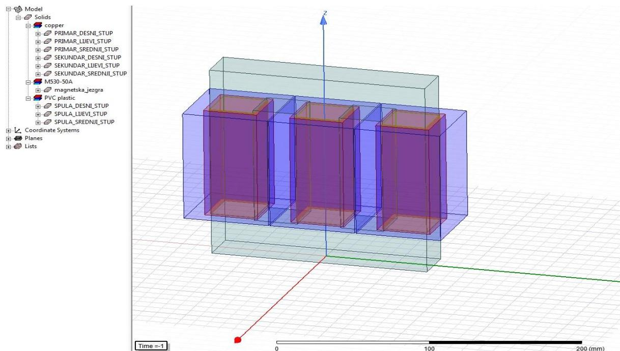
**Slika 4.31.** Kompletan geometrijski model transformatora Elektrosklop TPTO 200 VA u Ansys Maxwell 3D području
