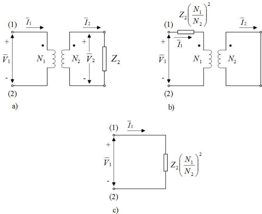
**Slika 2.12.** Svođenje impedancije idealnog transformatora na primarnu stranu
