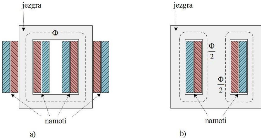
**Slika 2.7.** Shematski prikaz a) stupnog i b) ogrnutog transformatora
