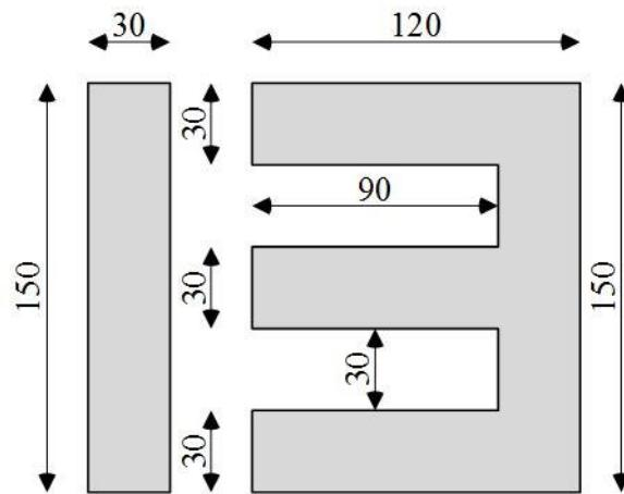
**Slika 4.1.** Dimenziije i oblik transformatorskih limova trofaznog transformatora Elektrosklop TPTO 200 VA
