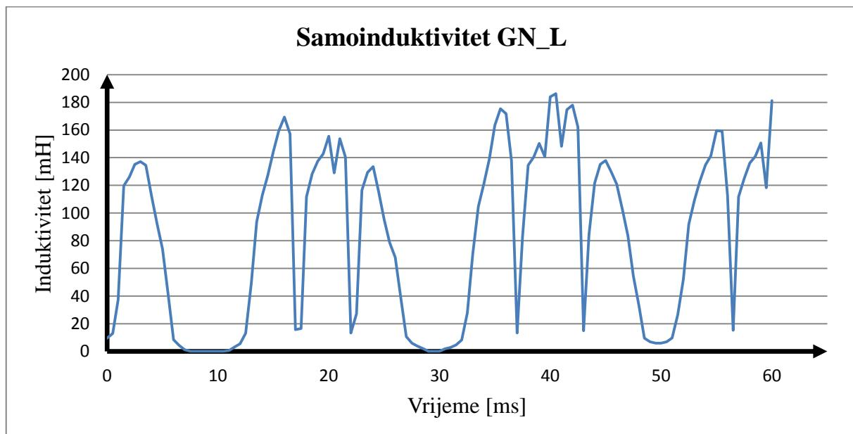
Slika 5.1. Samoinduktivitet gornjonaponskog namota na lijevom stupu modela transformatora
