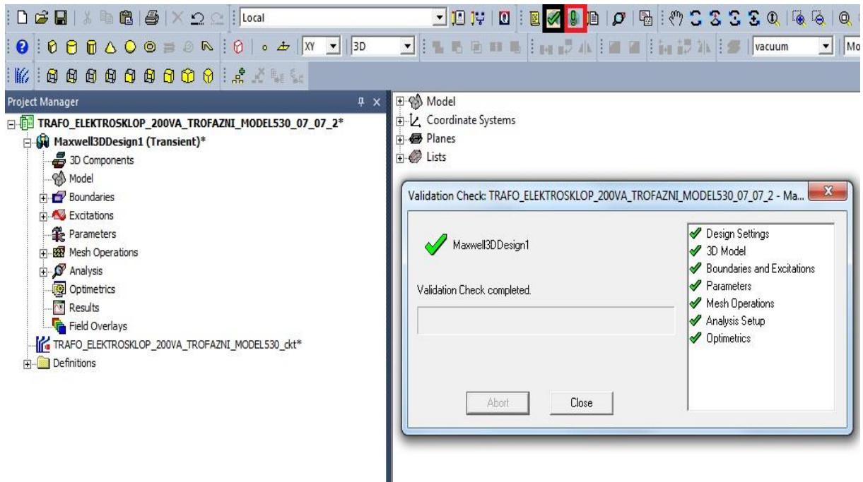
**Slika 4.55.** Provjera ispravnosti modela i pokretanje simulacije
