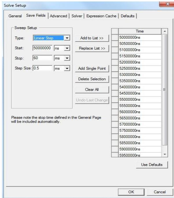
**Slika 4.46.** Save Fields podizbornik u Solve Setup prozoru
