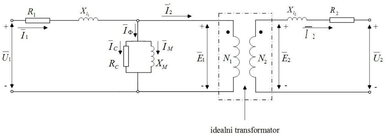
**Slika 2.16.** Razvojna nadomjesna shema transformatora sa sekundarnom stranom
