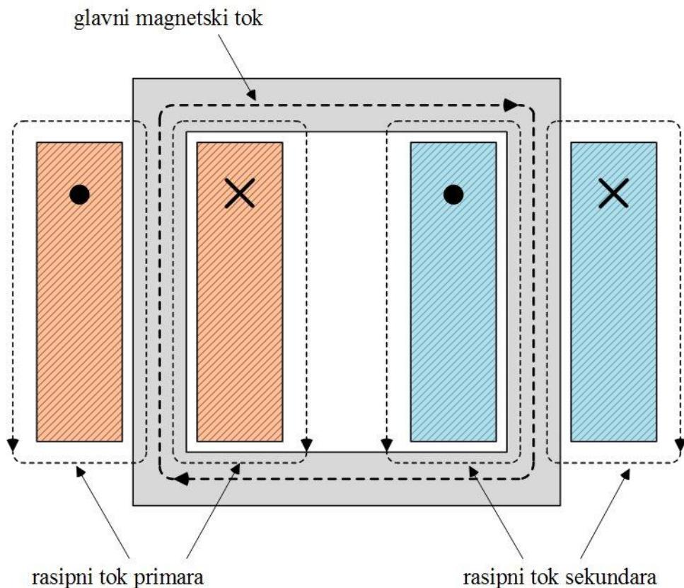
**Slika 2.13. Shematski prikaz transformatora i magnetskih tokova**
