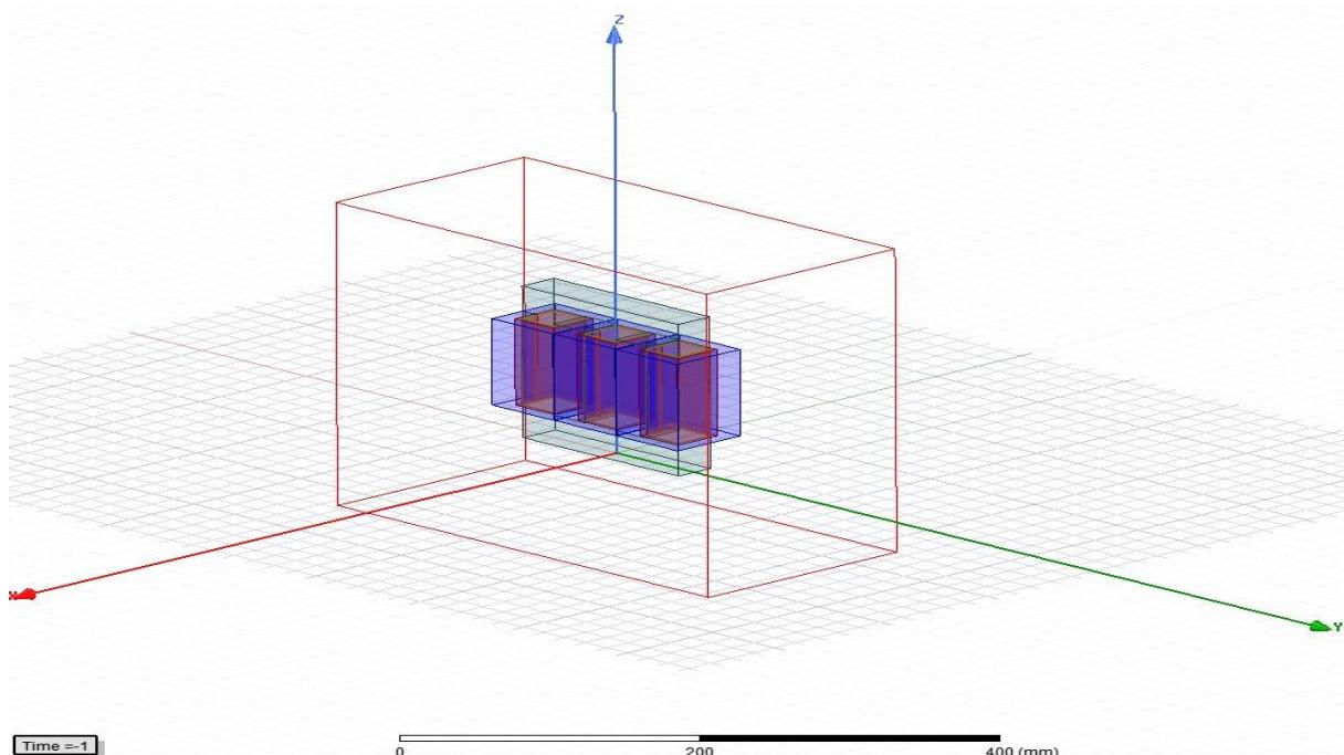
**Slika 4.43.** Model transformatora i regija u Ansys Maxwell 3D području
