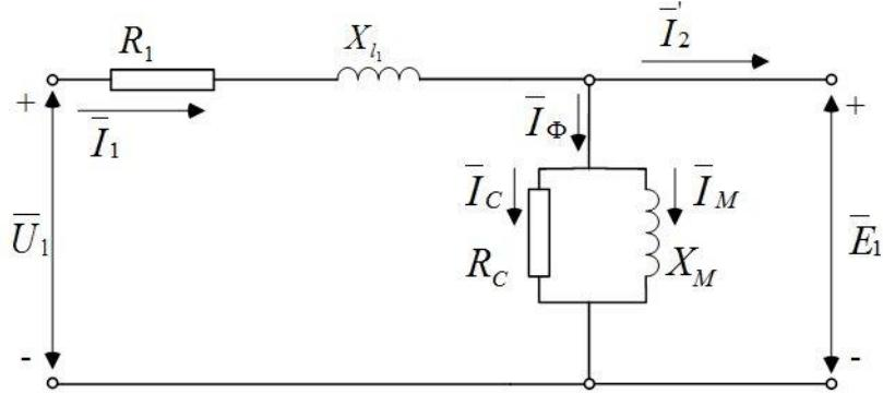
**Slika 2.15.** Razvojna nadomjesna shema s paralelnom granom
