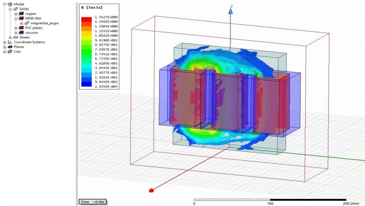
**Slika 5.14.** Prikaz intenziteta magnetske indukcije u magnetskoj jezgri
