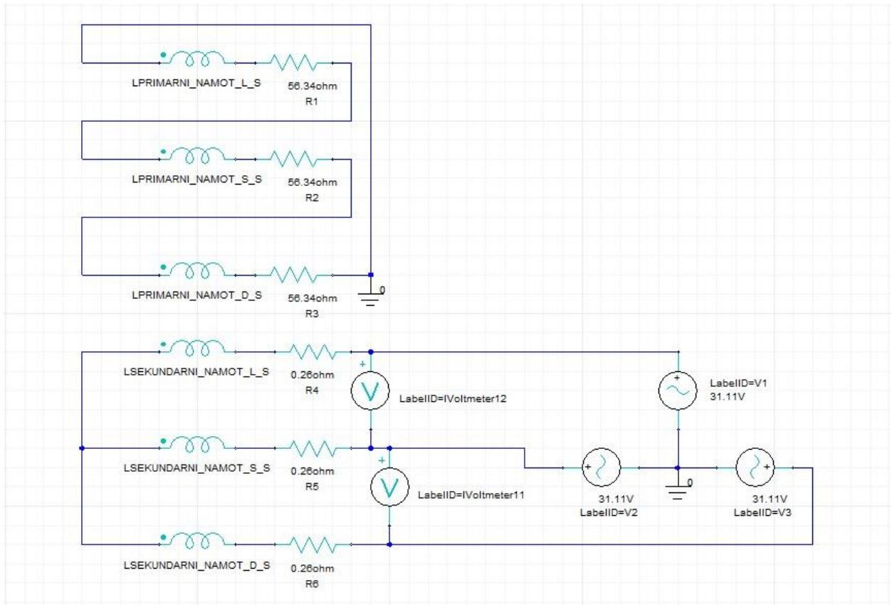
**Slika 4.50.** Električna shema modela transformatora Elektrosklop TPTO 200 VA
