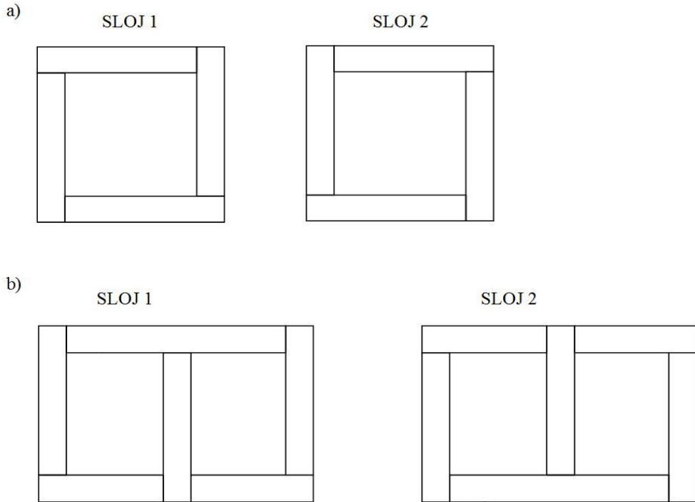
**Slika 2.8.** Postavljanje transformatorskih limova koji čine jezgru transformatora
