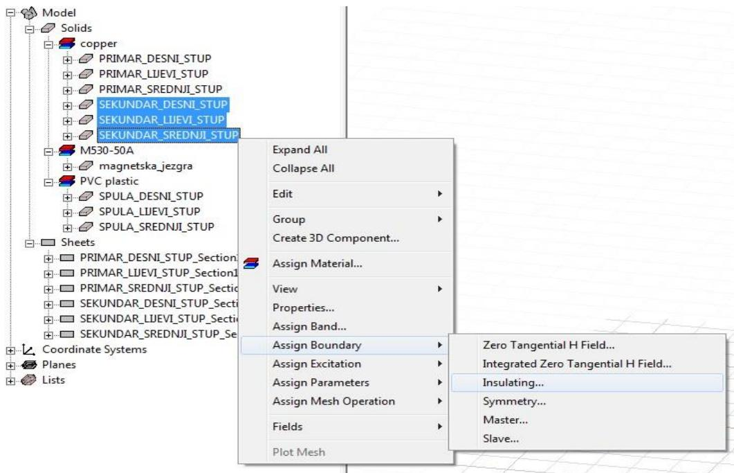
**Slika 4.39.** Postavljanje izolacije na sekundarne namote transformatora
