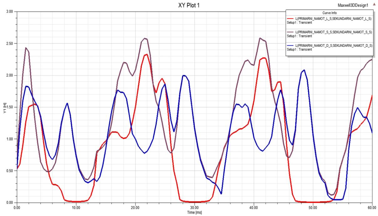
**Slika 5.19.** Međuinduktiviteti između istoimenih namota modela transformatora
