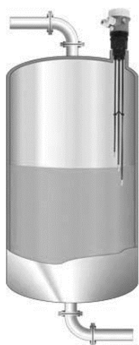
Sl 3.29. Konduktivna mjerila razine
