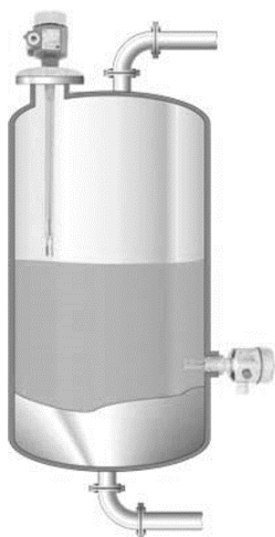
Sl. 3.26. Vibracijski detektori razine
