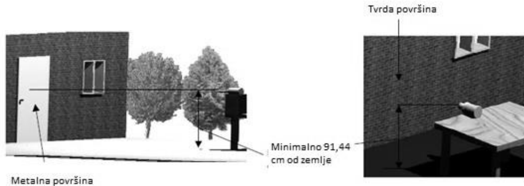
Sl.3.47. Umjeravanje uz pomoć ravne i tvrde površine
