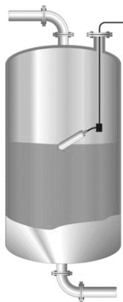
Sl. 3.3. Detektor razine s plovkom
