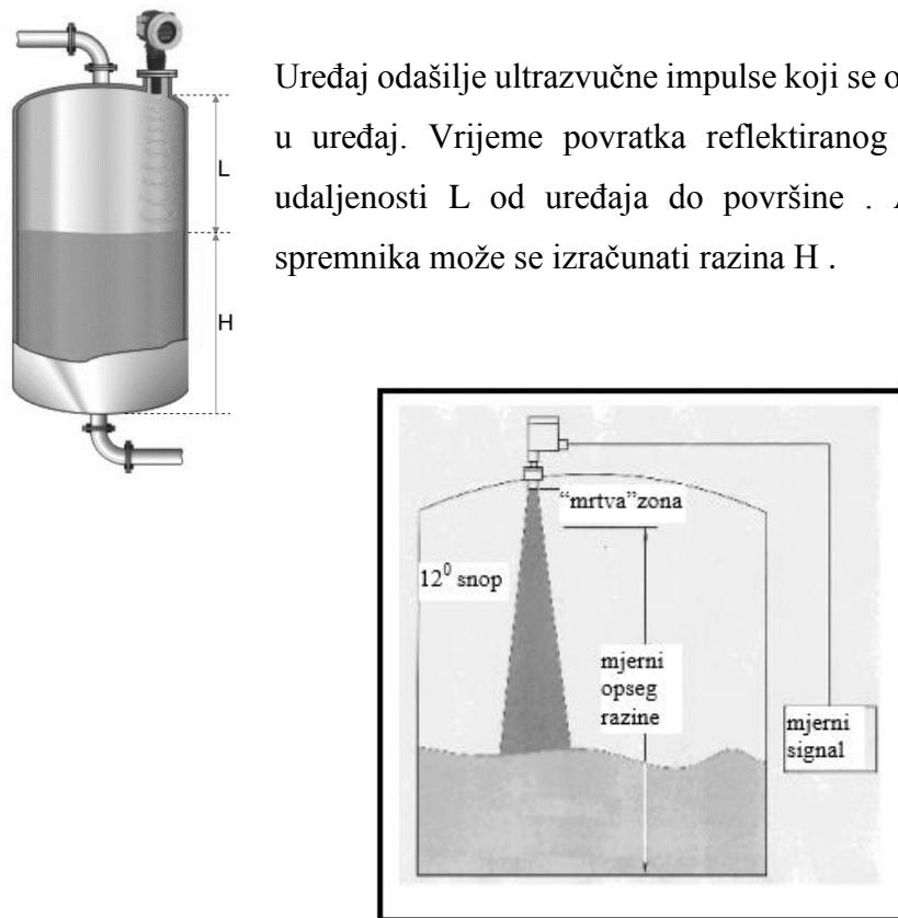
Sl. 3.18. Shematski prikaz prostiranja ultrazvučnog vala za mjerjenje razine.
