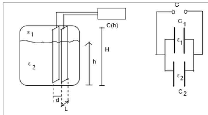
S1.3.13. Shematski prikaz načela kapacitivnog mjerjenja razine
