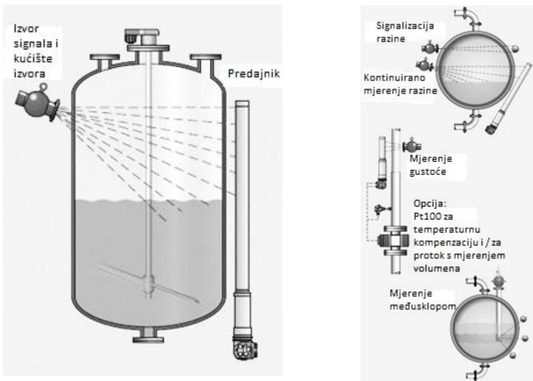
Sl.3.39. Princip mjerena radijacijskog mjerila razine
