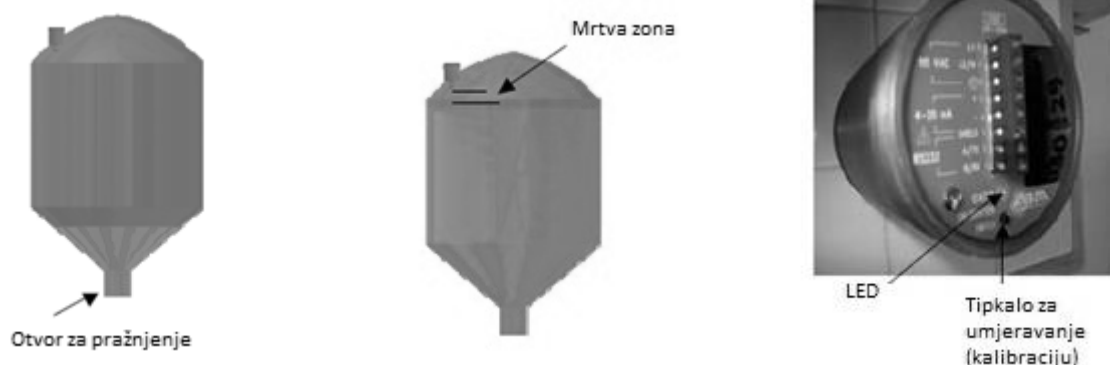
Sl.3.46. Unutarnje umjeravanje spremnika
