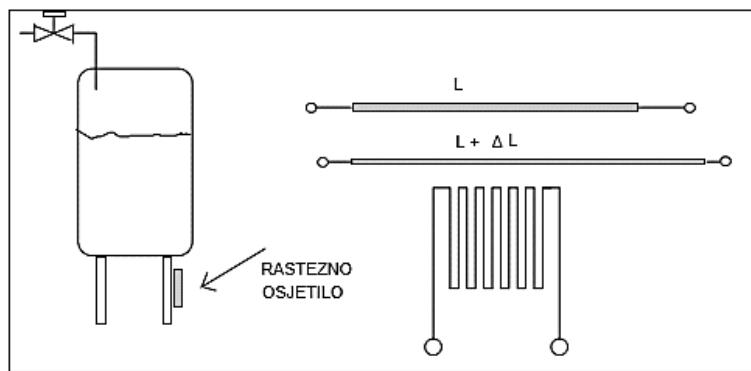
Sl. 3.16. Shematski prikaz načela mjerjenja razine rasteznim osjetilom.
