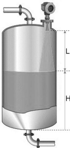
Uredaj odašilje radarske impulse od površine i vraća ju u uređaj. Vrijeme povratka reflektiranog impulsa je proporcionalno udaljenosti  $L$  od uređaja do površine.
