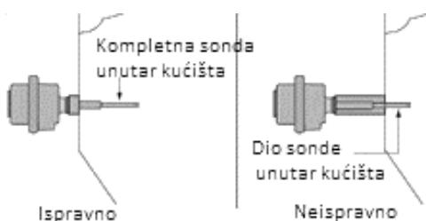
Slika 3.51. Način montaže osjetila kod medija s malom dielektričnom konstantom
