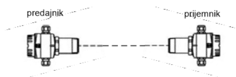
Sl. 3.32. Princip rada mikrovalnog mjerila razine
