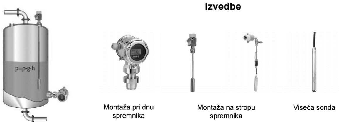
Sl.3.8. Mjerenje razine zatvorenog spremnika
