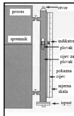
Sl. 3.2. Mjerni uređaj za mjerjenje razine s pokaznom cijevi.
