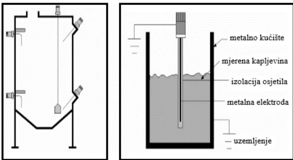
Sl. 3.14. Primjeri kapacitivnog mjerjenja razine: A) signalizacija graničnih položaja, B) mjerjenje razine vodljive kapljevine.
