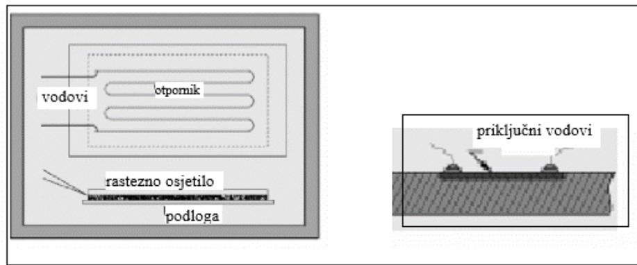
Sl. 3.17. Shematski prikaz rasteznih osjetila: A) metalni vodič, B) poluvodič
