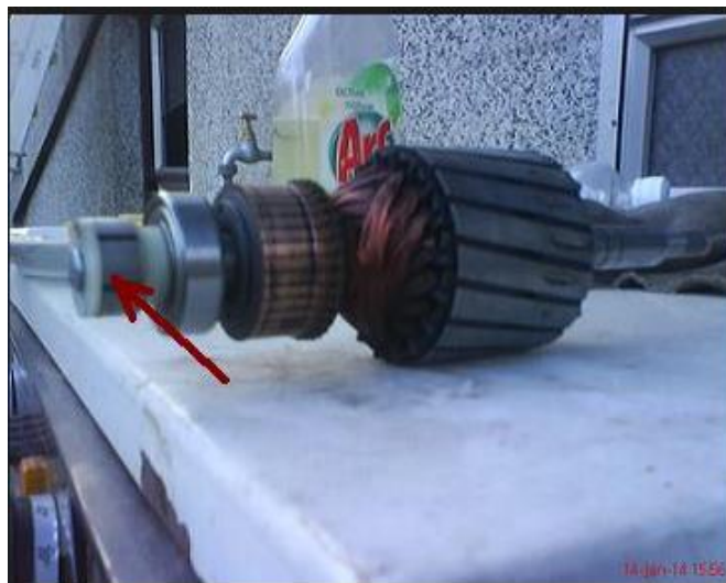
Sl. 3.1. Tahogenerator priključen na osovinu[8].
