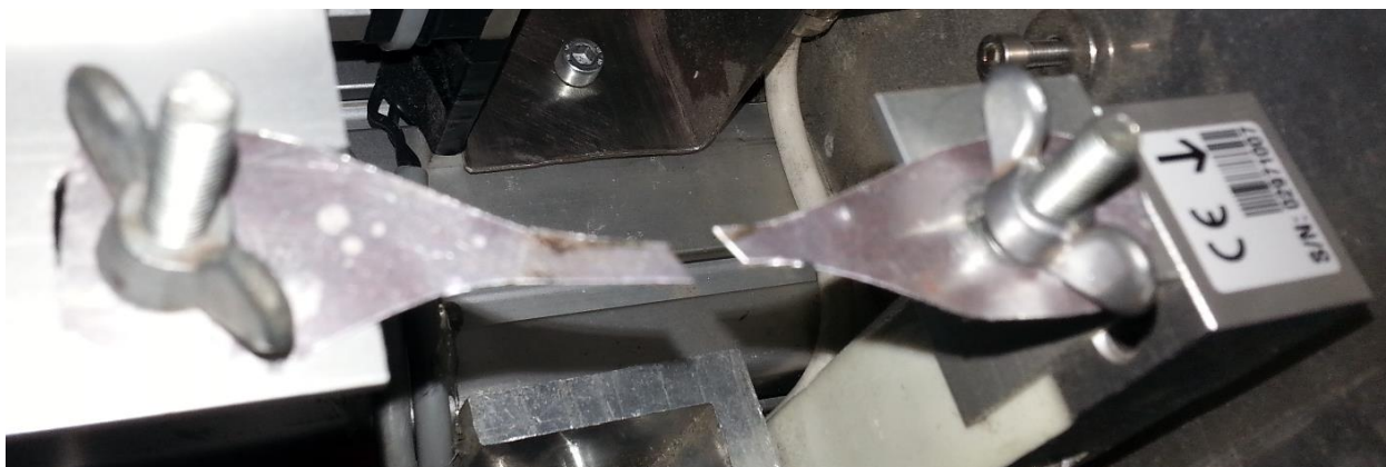
Slika 6.5. Izgled puknuća čeličnog lima prilikom kidanja
