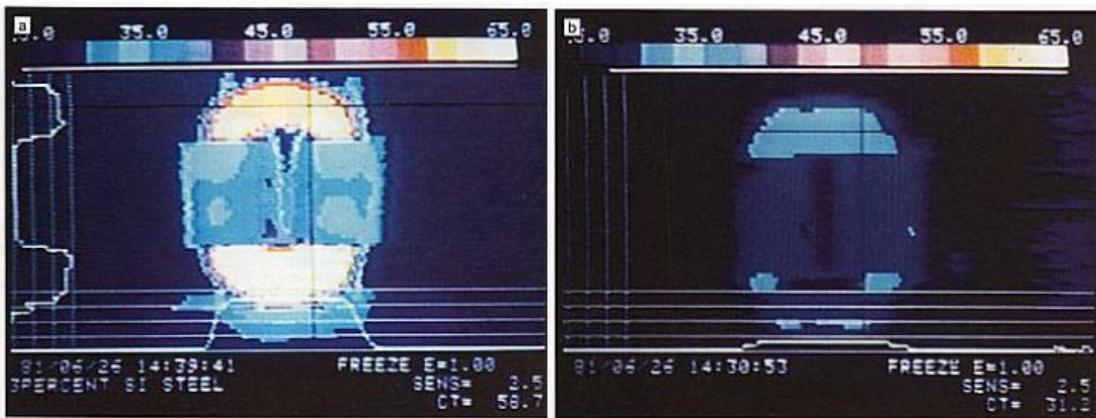
**Sl. 6.9:** Infracrvena analiza: a) klasični distributivni transformator, b) amorfni transformator.
