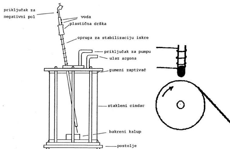
**Sl. 6.2:** Tehnika dobivanja amorfognog lima ultrabrzim kaljenjem iz tekućeg stanja. [14]
