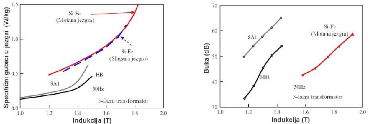
**Sl. 6.6:** Usporedba specifičnih gubitaka jezgre i buke za transformator od amorfnih materijala i magnetski orientiranog lima. [10]
