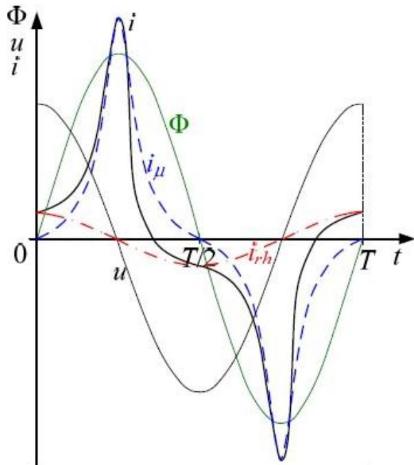
**Sl. 2.4:** Rastavljanje struje magnetiziranja na radnu i jalovu komponentu. [1]
