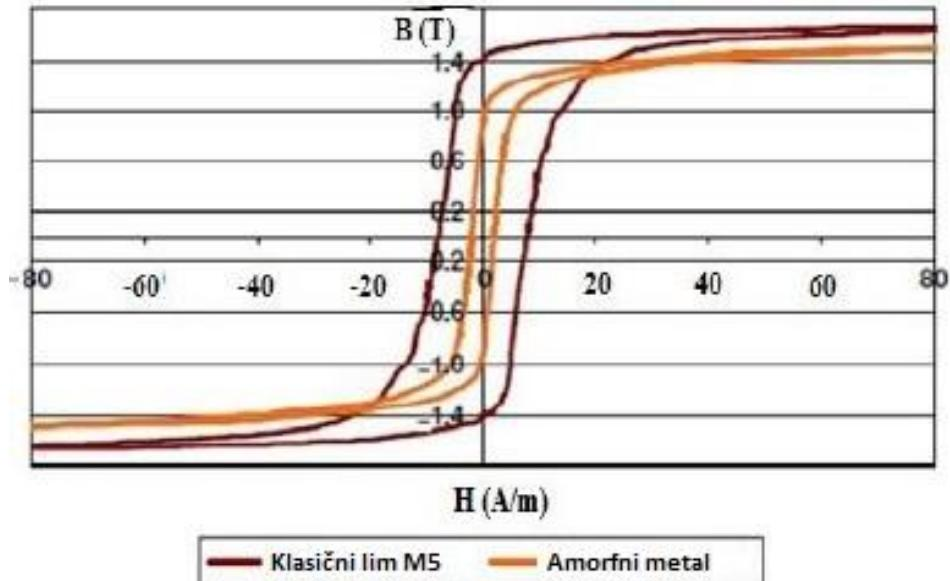
**Sl. 6.5:** Krivulja magnetiziranja amorfног metala i klasičnog magnetski orijentiranog lima M5. [21]
