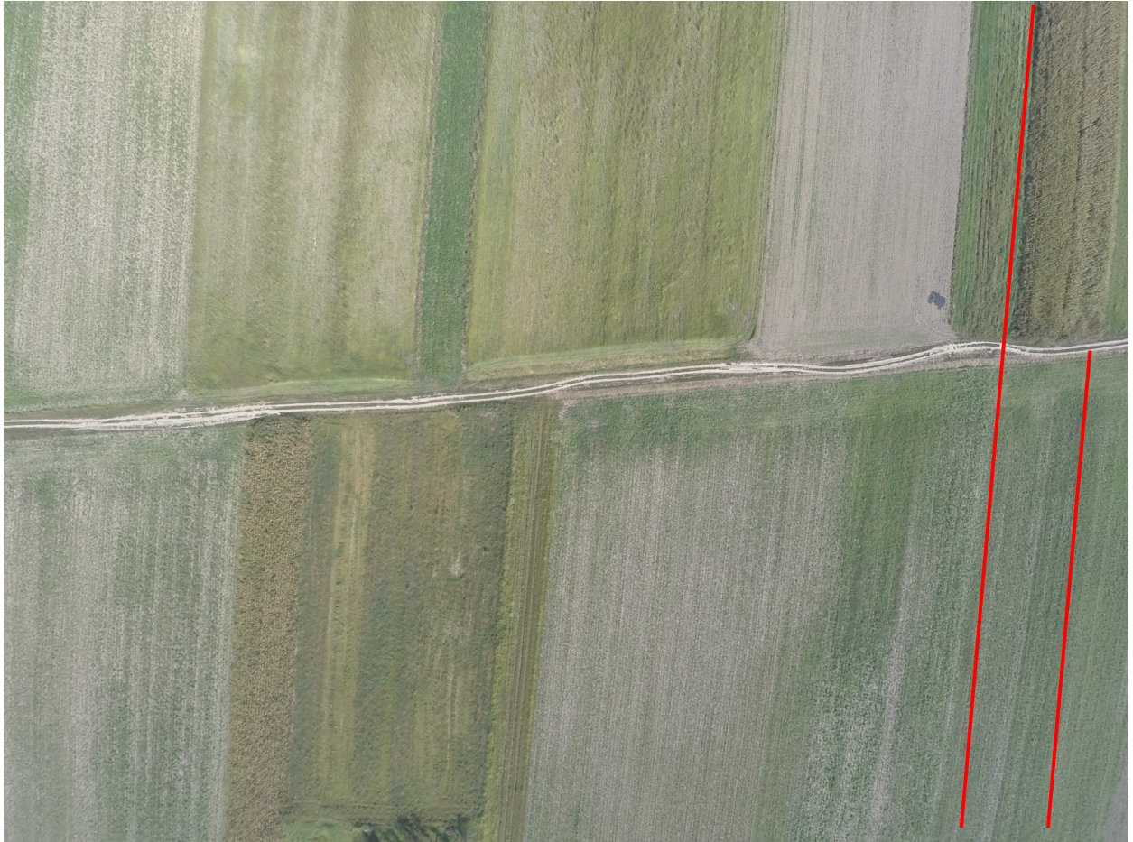
Sl. 4.2 - uklanjanje izobličenja principom šahovske ploče
