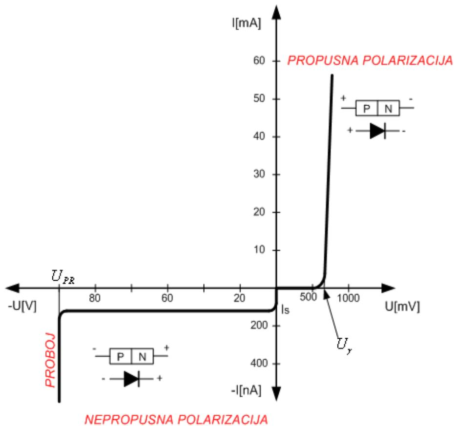
**Slika 3.1.2.** Strujno naponska karakteristika PN diode[8]
