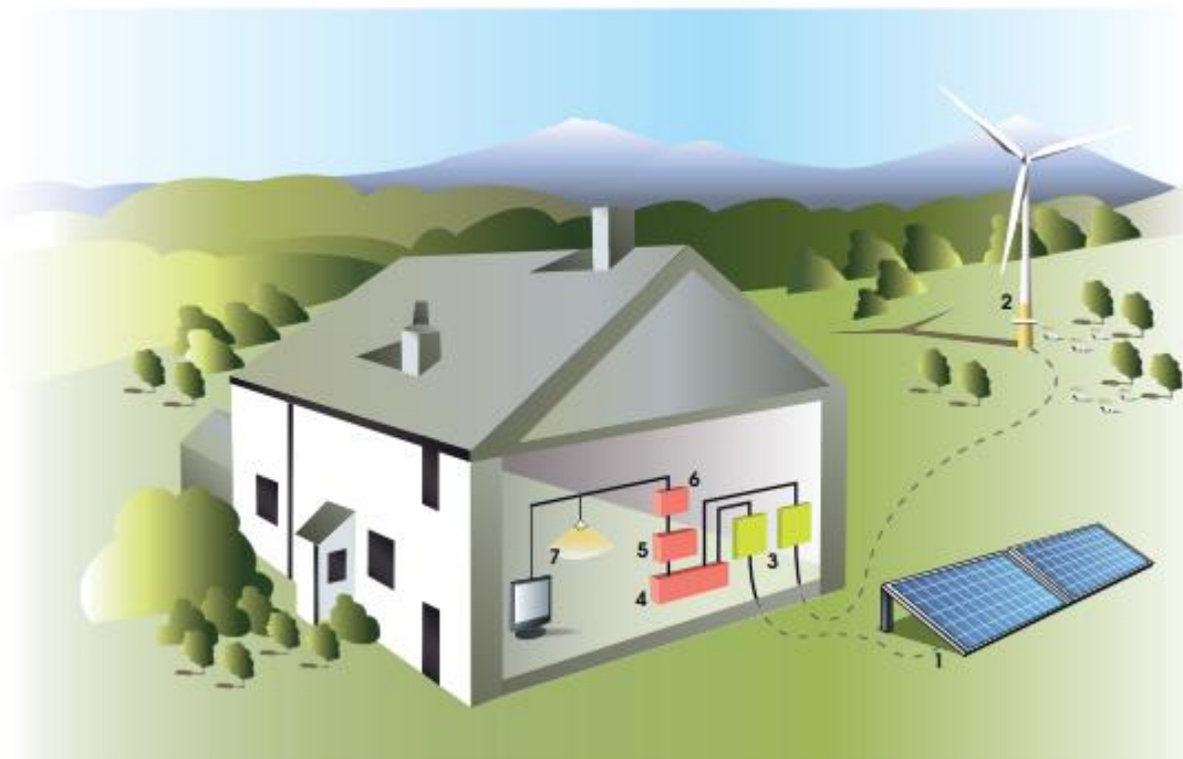
Slika 3.4.1. Prikaz samostalnog sustava za seosko domaćinstvo[13]
