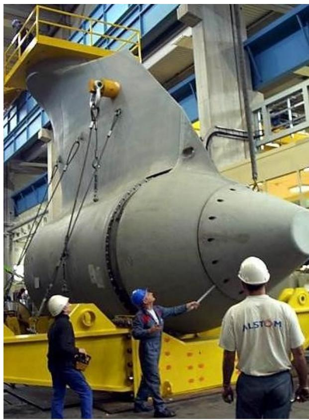
*Slika 5.3.5. Azipod propellerski pogon*
