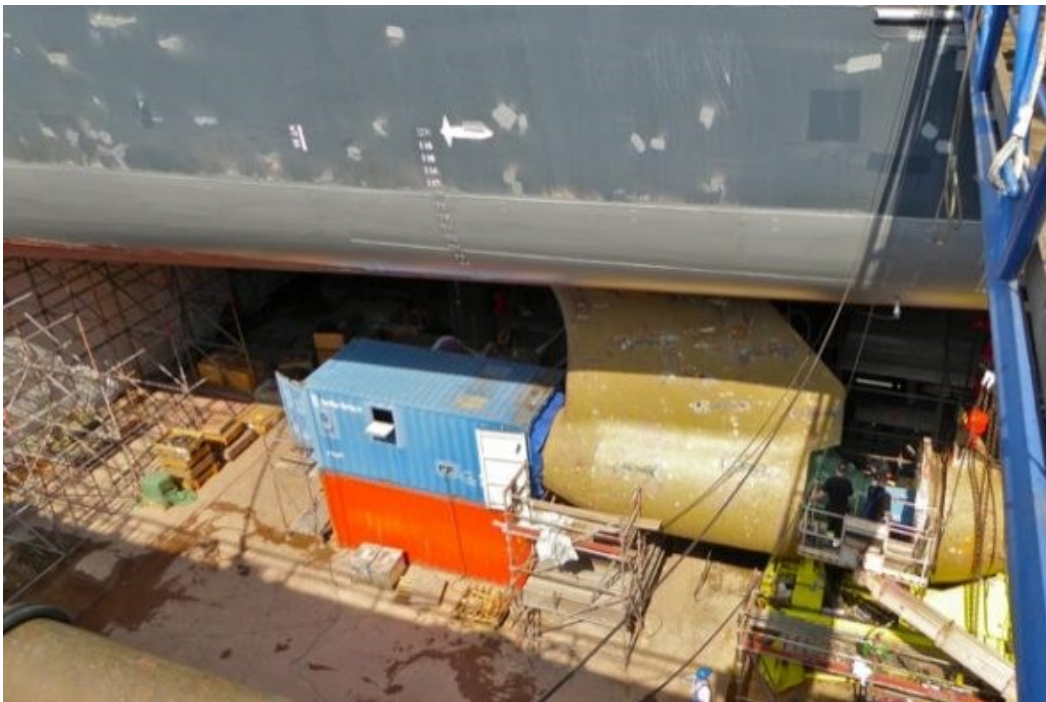
Slika 5.5.2. Rekonstrukcija FPP propelera firme Rolls Royce
