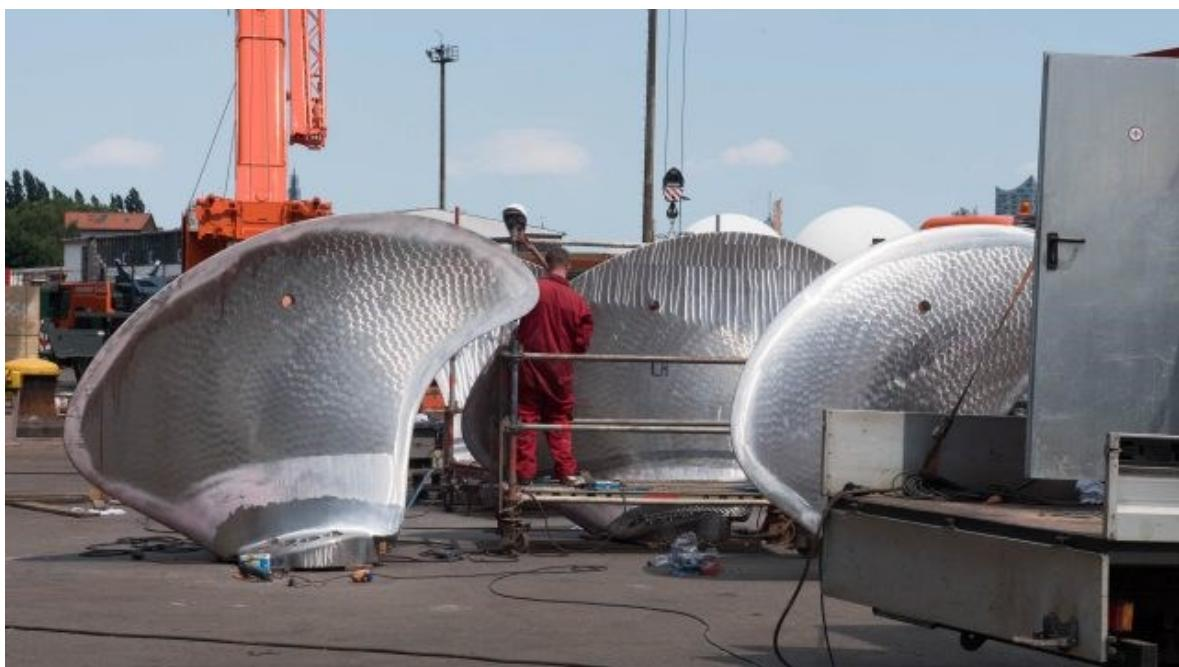
*Slika 5.5.3. Nova krila za propelere firme Rolls Royce*
