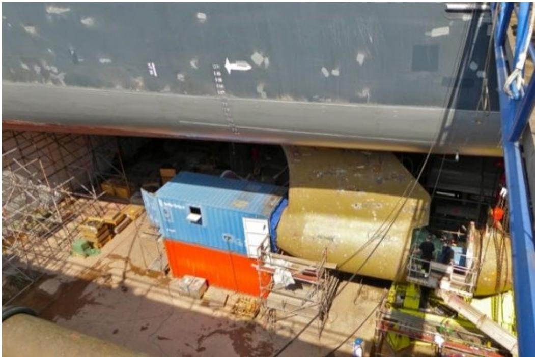
*Slika 5.5.2. Rekonstrukcija FPP propelera firme Rolls Royce*
