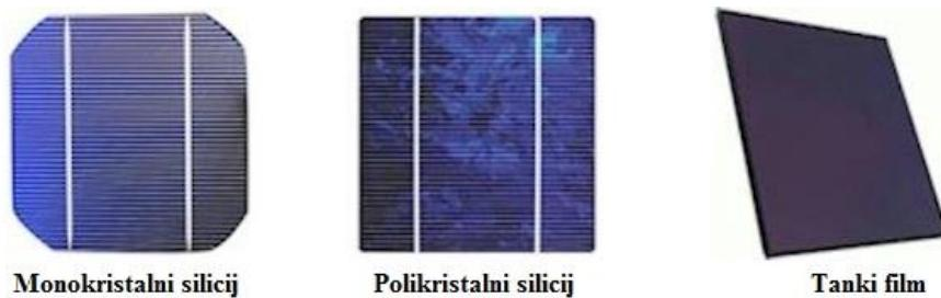
**Slika 2.1:** Prikaz opisanih fotonaponskih ćelija.
