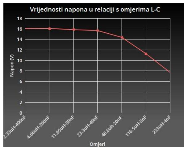
**Sl. 3.21.** Graf odnosa napona te omjera induktiviteta i kapaciteta u serijskom krugu
