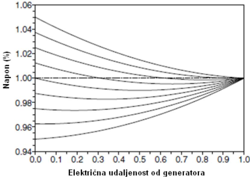
Slika 4.7 Napon duž distribucijske mreže za različite vrijedsnosti porasta napona na stezaljkama generatora. Generator je s lijeve,a izvor s desne strane.[4]
