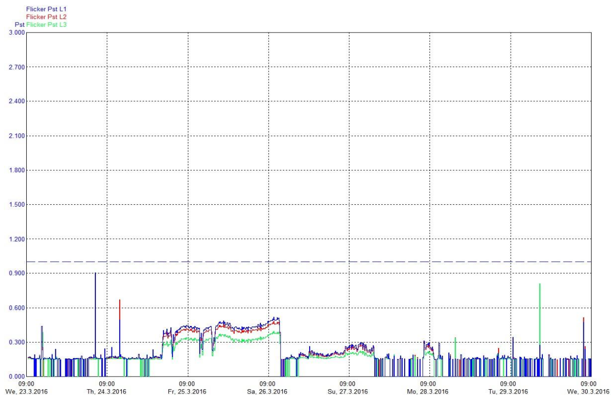
Slika 8.9. Kratkotrajno naponsko treperenje (flikeri), nakon priključenja BPP.
