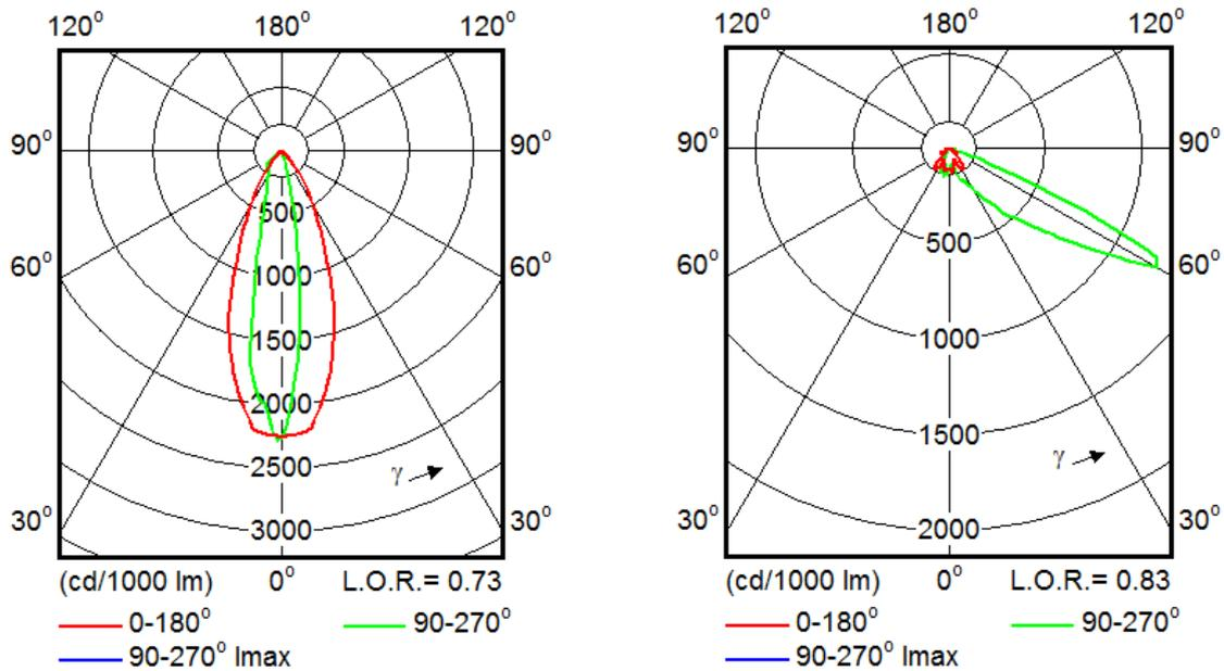
Slika 3.3 Simetrična (lijevo) i asimetrična (desno) svjetiljka [20]
