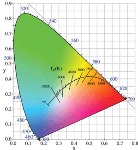
Slika 2.6 Trikromatski dijagram [4]
