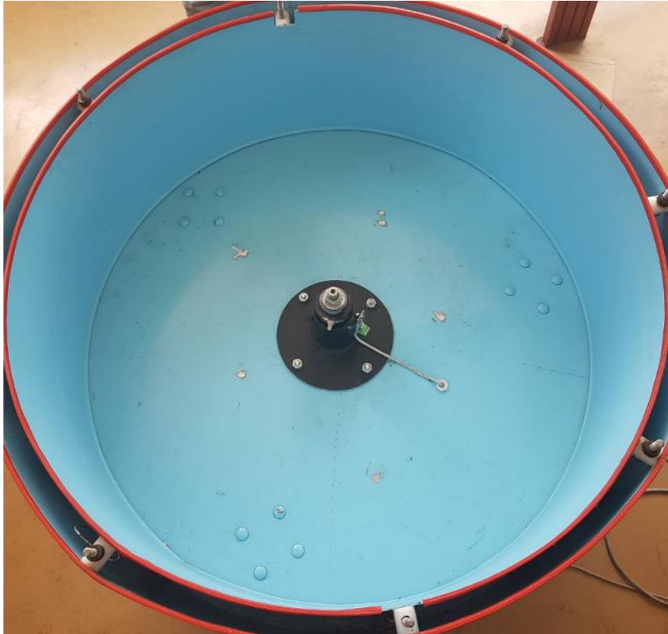
Sl. 4.11 Bujanj za testiranje zemlje
