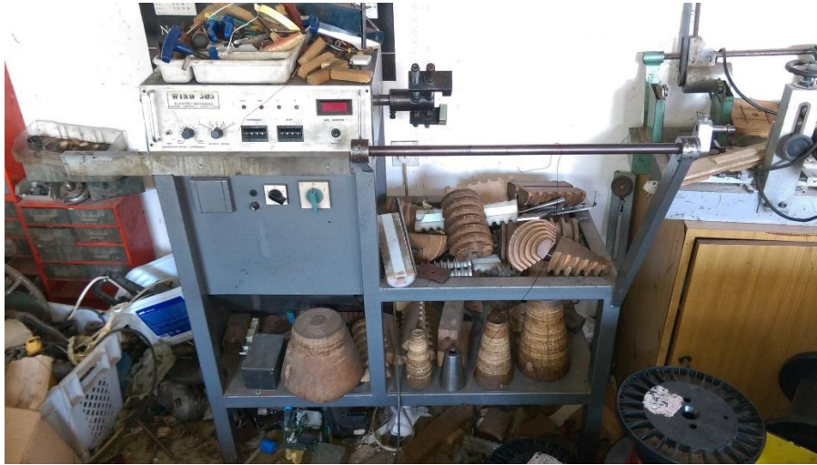
Sl.4.13. Stroj za izradu zavojnice
