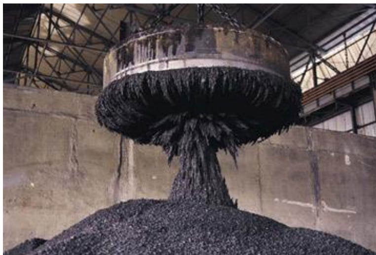
Sl.4.9. Primjena elektromagneta u industriji [12]
