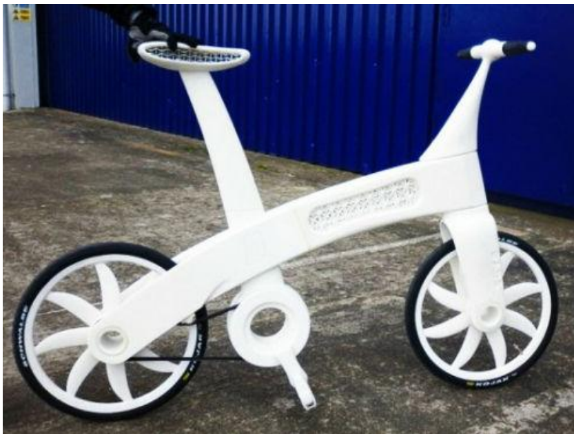
Slika 2.2. Bicikl napravljen na 3D printeru [14]
