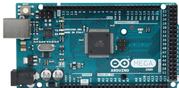
Sl. 2.3. Arduino Mega maketa s ATmega2560 mikroupravljačem
