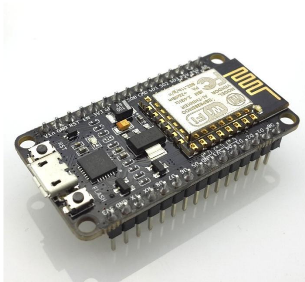
Sl. 2.9. NodeMCU (ESP8266)
