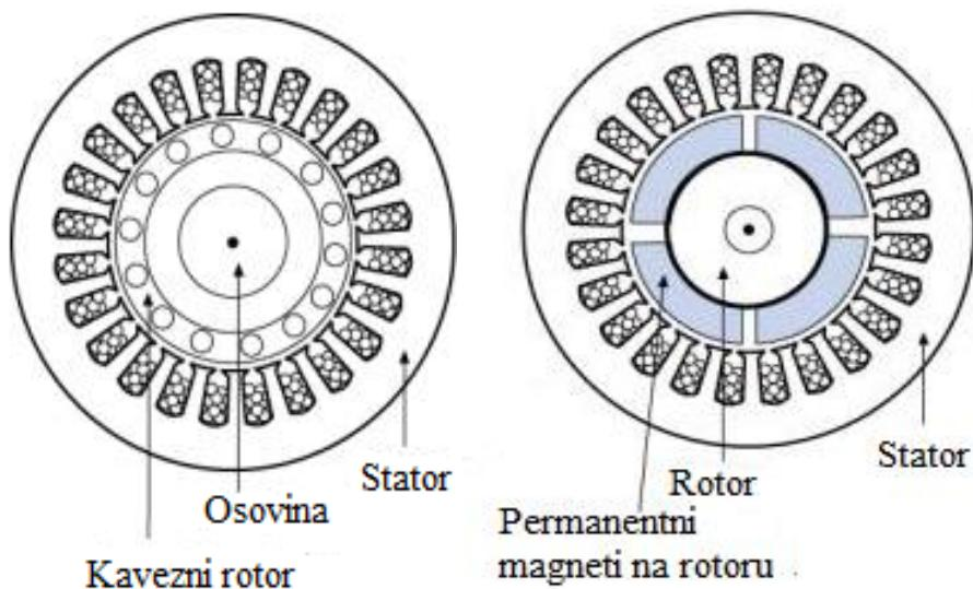
Slika 3.13 Usporedba asinkronog i BLDC motora [13]
