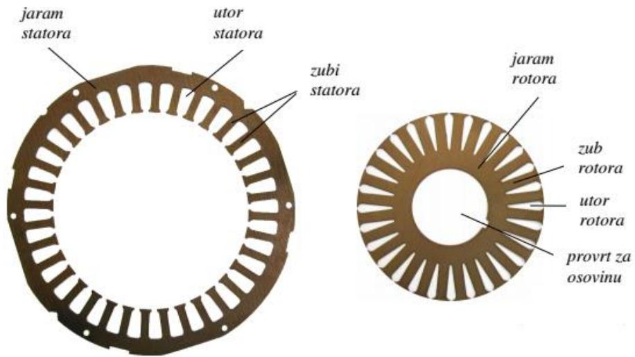
**Slika 3.4** Stator i rotor kavezognog asinkronog stroja [8]
