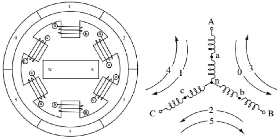
**Slika 3.10** Poprečni presjek BLDC motora i redoslijed napajanja faza [9]
