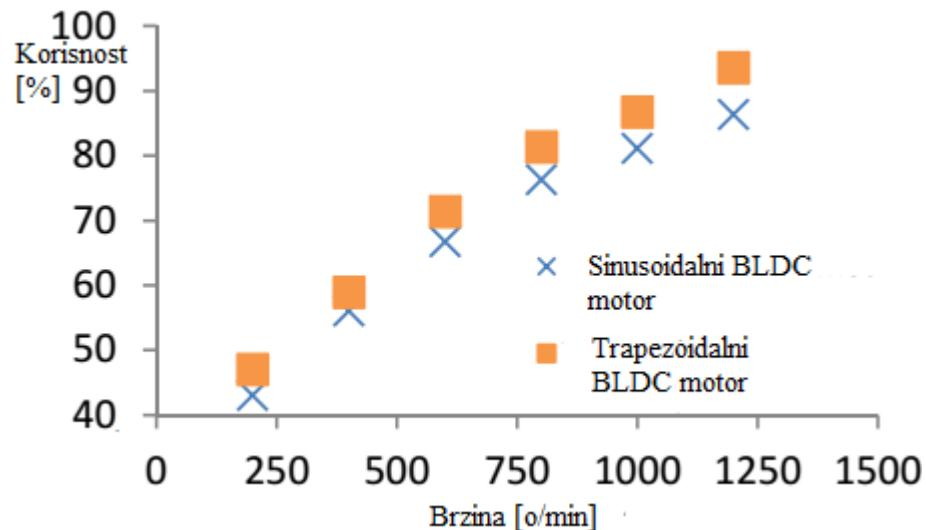
**Slika 3.7** Usporedba korisnosti trapezoidalnog i sinusoidalnog BLDC motora [10]
