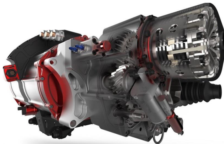
Slika 4.3 Motor i prijenosni sustav (reduktor) Concept_One [23]
