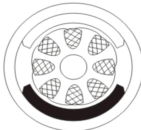
**Slika 3.12** BLDC motor sa izvedbom vanjskog rotora [11]
