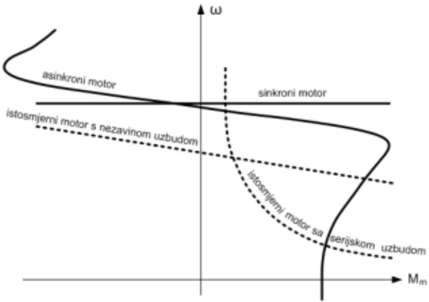
**Slika 3.5** Mehaničke karakteristike više različitih vrsta električnog motora [5]
