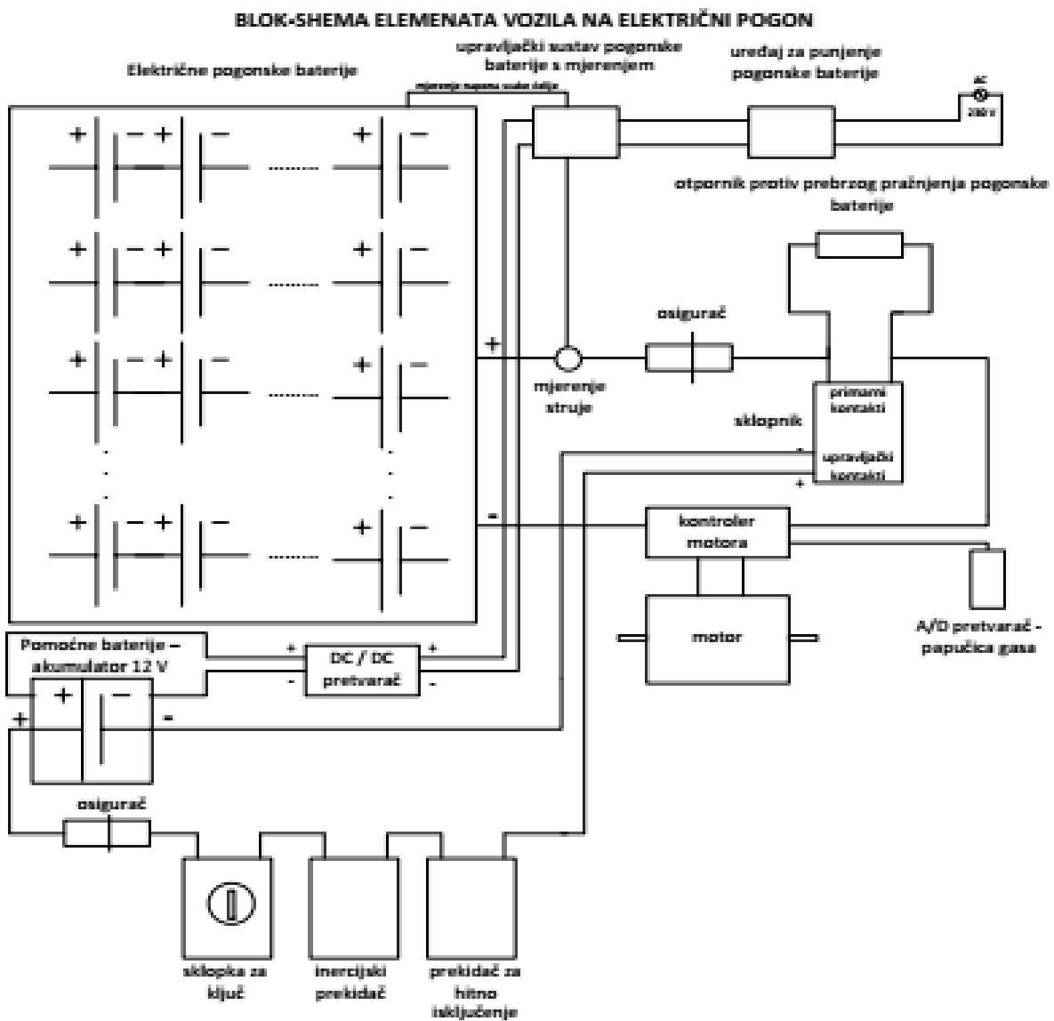
**Slika 3.1** Blok – shema elemenata automobila na električni pogon [5]
