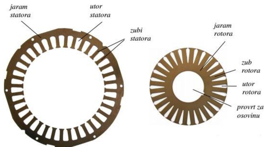
**Slika 3.4** Stator i rotor kaveznog asinkronog stroja [8]
