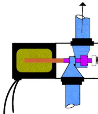
Slika 3.15: Elektromagnetski ventil u otvorenom položaju, [11].
