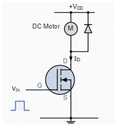
**Shema 3.1:** Spajanje N-kanalnog MOSFET tranzistora sa mikrokontrolerom i motorom, [5].
