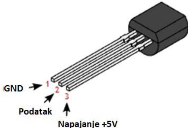
Slika 3.9: DS18B20 temperaturni senzor.
