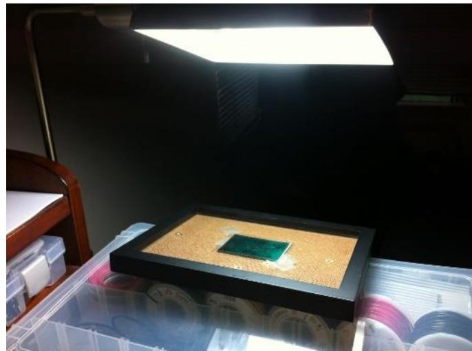
**Slika 3.29:** Osvjetljivanje pločice.
