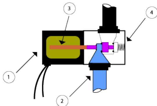
Slika 3.14: Elektromagnetski ventil u zatvorenom položaju, [11].
