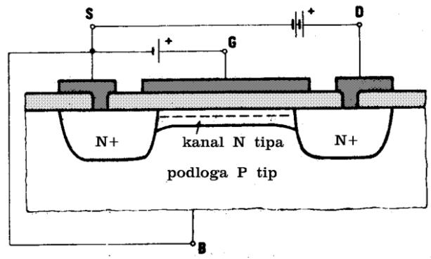
Slika 3.18: Spoj i formiranje kanala na MOSFET tranzistoru, [18].
