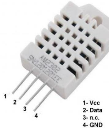
**Slika 3.7:** Izgled i raspored pinova AM2302 senzora, [6].
