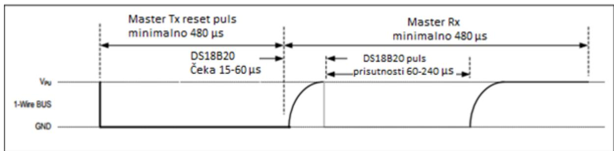
Slika 3.10: Početak komunikacije između senzora i mikrokontrolera, [16].
