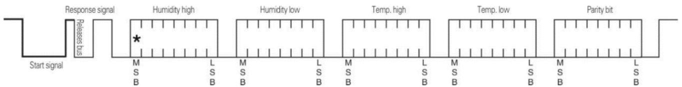
**Slika 3.8:** Komunikacija između mikrokontrolera i senzora, [6].
