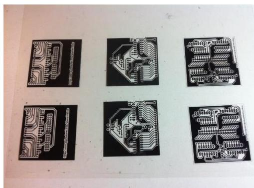
Slika 3.28: Isprintan nacrt vodova na prozirnoj foliji.
