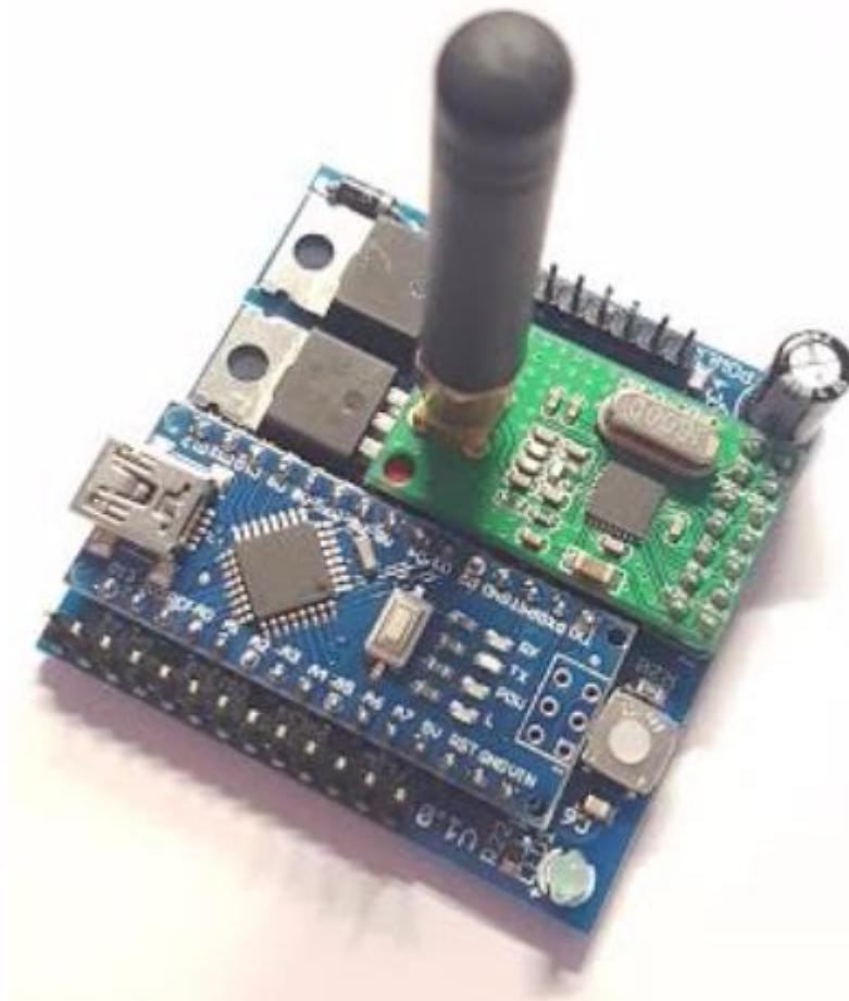
**Slika 3.34:** Izgled izvršne jedinice nakon sastavljanja na tiskanoj pločici.
