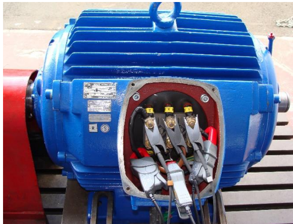
Sl. 4.3. Prikaz asinkronog motora korištenog pri ispitivanju.[4]
