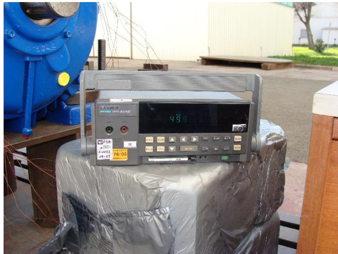
Sl. 4.4. „Instrumentarij za ispitivanje zagrijavanja elektromotora 47 kW, Ex e“.[4]
