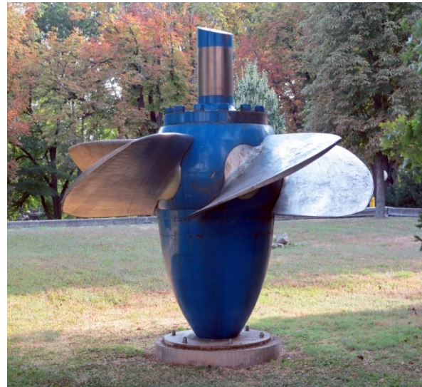
Slika 2.8. Izgled Kaplanove turbine
