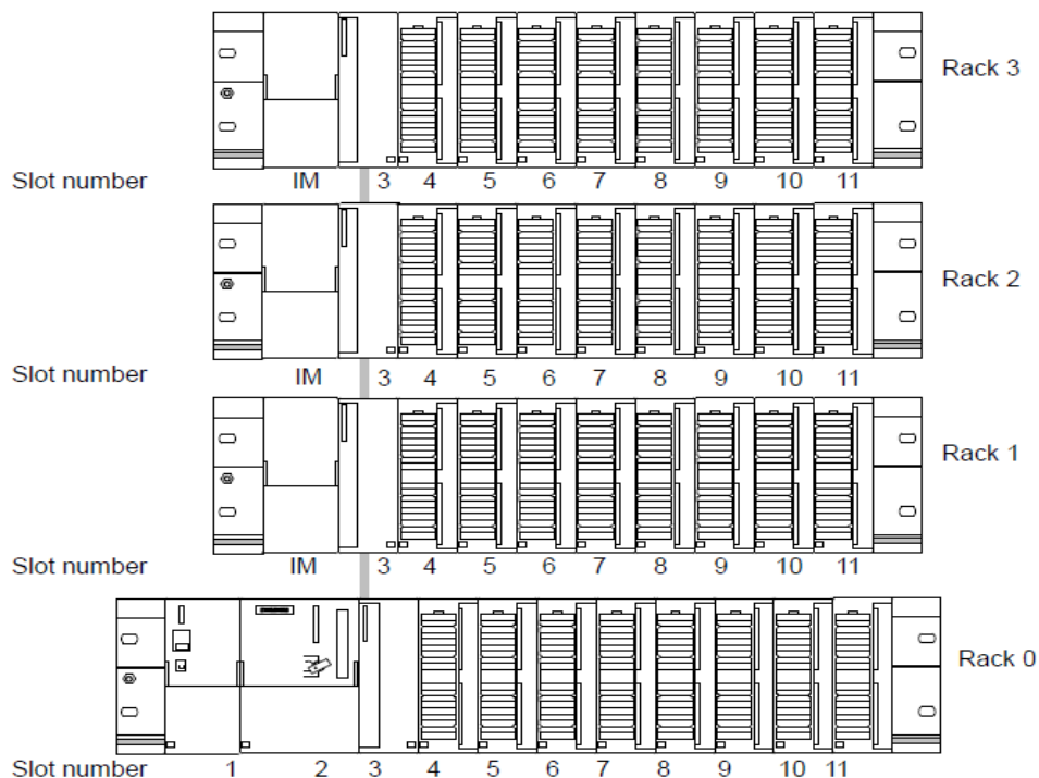
Sl. 2.3. Četverookvirna konfiguracija S7-300 PLC-a s jednim CPU-om [13.]
