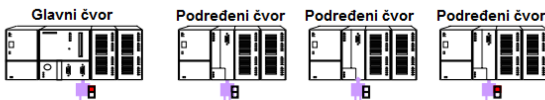
Sl. 2.4. Zaključni otpornik na PROFIBUS DP kabelu.
