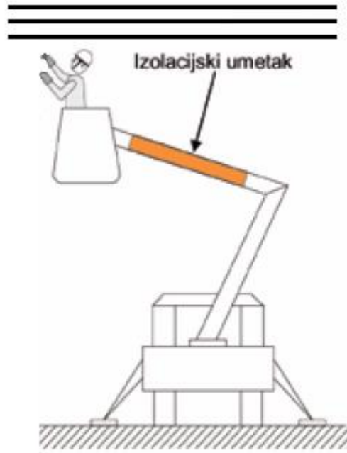
Sl. 3.11. Hidraulička autoplatforna s izolacijskim umetkom [2]
