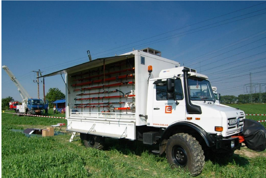
Sl. 3.10. Teretno vozilo za transport opreme za RPN [10]
