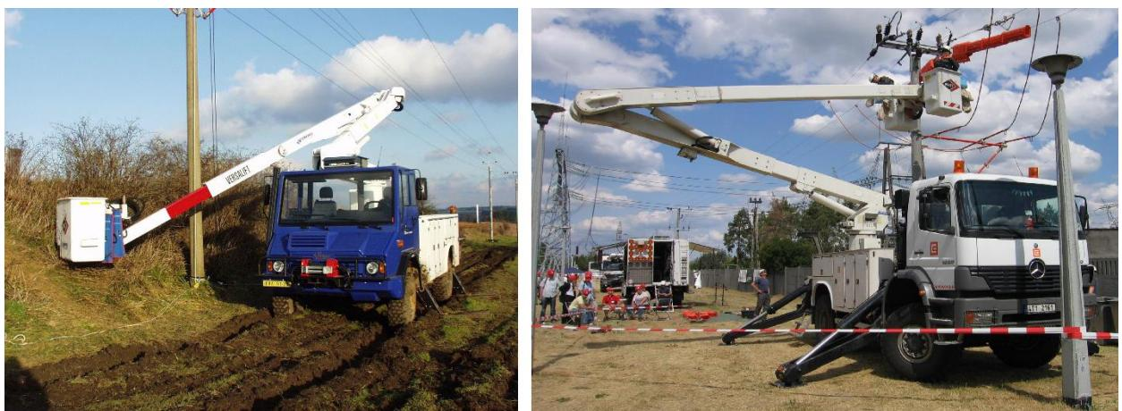
**Sl. 3.12. Različite izvedbe hidrauličnih autoplatformi [10,11]**
