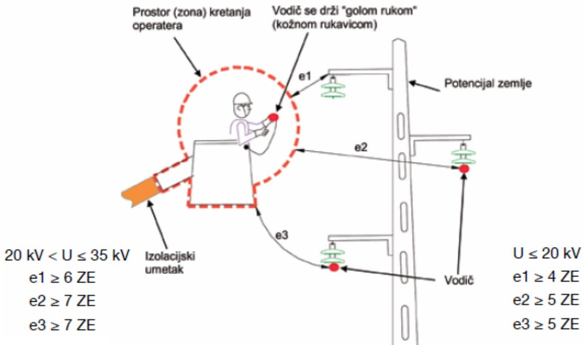
**Sl. 2.5.** Rasporед i broj zaštitnih elemenata u RPN-u metodom rada „na potencijalu“ iz košare hidrauličke autoplatorme s izolacijskim umetkom [5]
