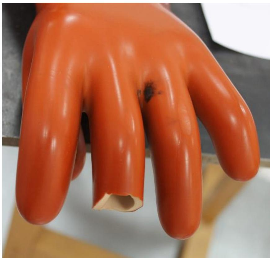
**Sl. 3.6.** Oštećene kompozitne izolacijske rukavice za RPN
