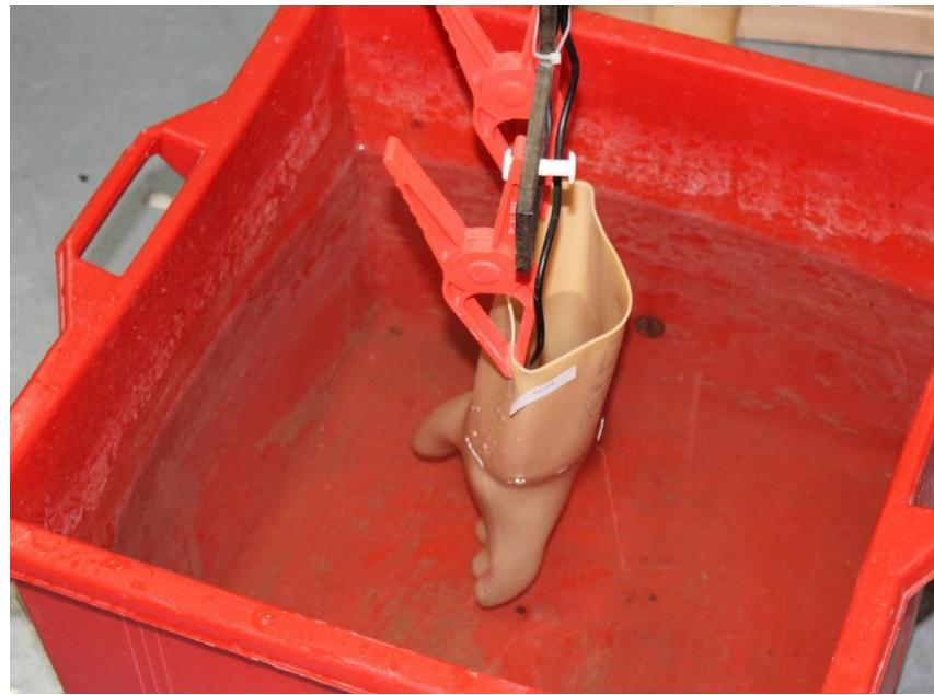
Sl. 3.15. Dielektrično ispitivanje izolacijske rukavice za RPN
