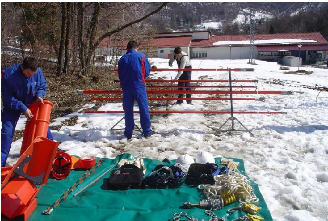
Sl. 3.8. Silikoniziranje izolacijskih motki, pokrivača i pravilno odlaganje alata [6]
