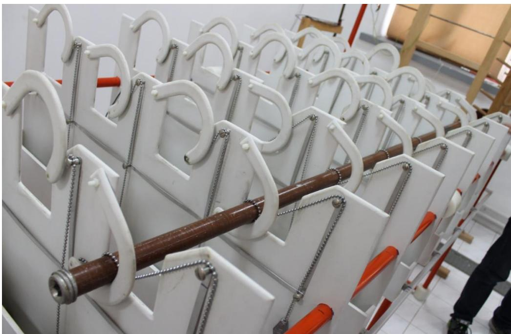
**Sl. 3.14.** Dielektrično ispitivanje izolacijske motke za RPN
