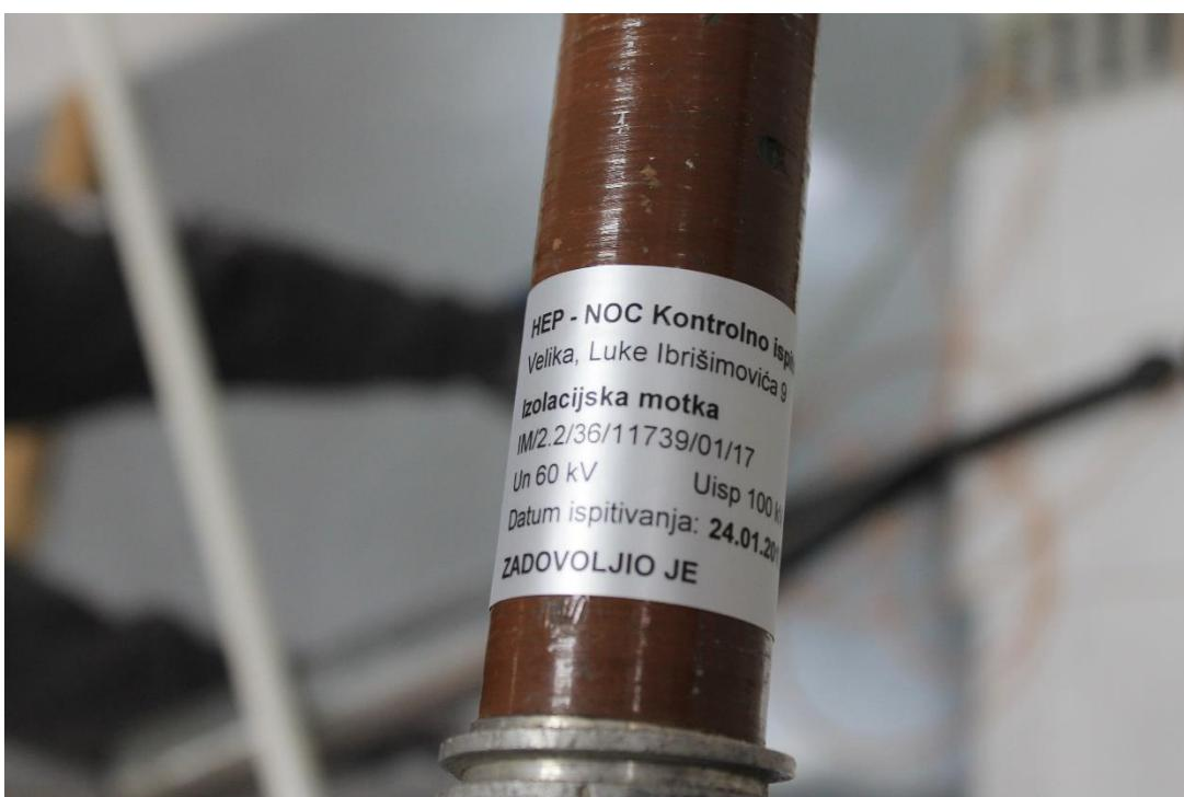
Sl. 3.17. Naljepnica s podacima kontrolnog ispitivanja
