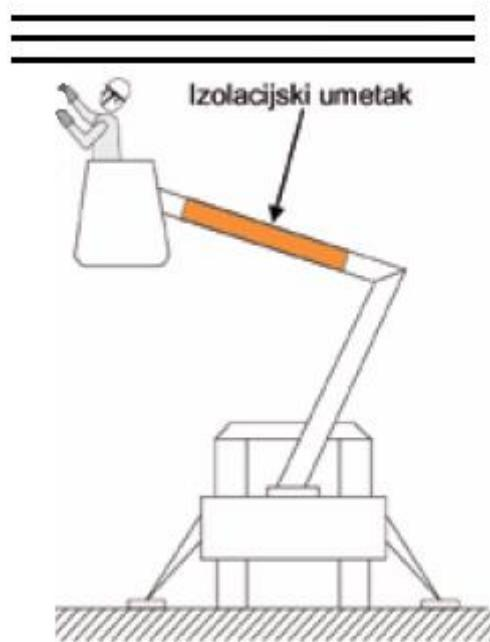
Sl. 3.11. Hidraulička autoplatforma s izolacijskim umetkom [2]
