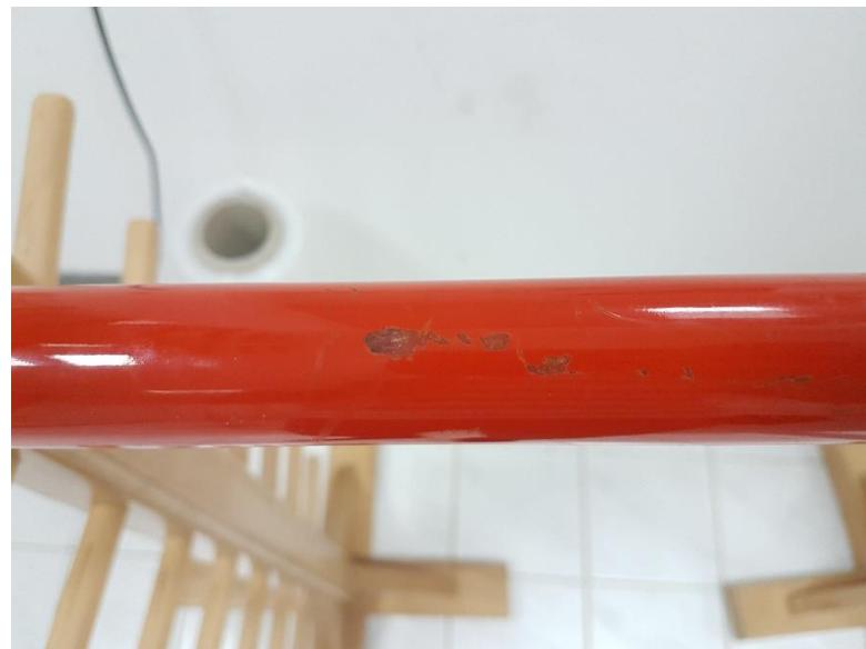
*Slika 4.3. Površinsko oštećenje izolacije uzemljivačke motke*
