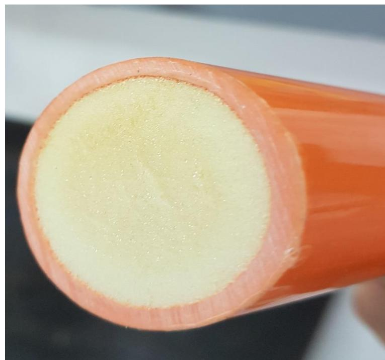
*Slika 4.4. Presjek izolacije uzemljivačke motke*
