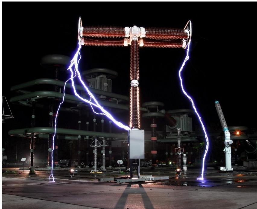
*Slika 3.1. Prenaponsko ispitivanje 550 kV-nog VN prekidača*
