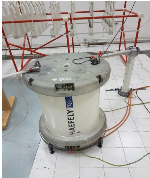
Slika 4.8. VN laboratorijski transformator
