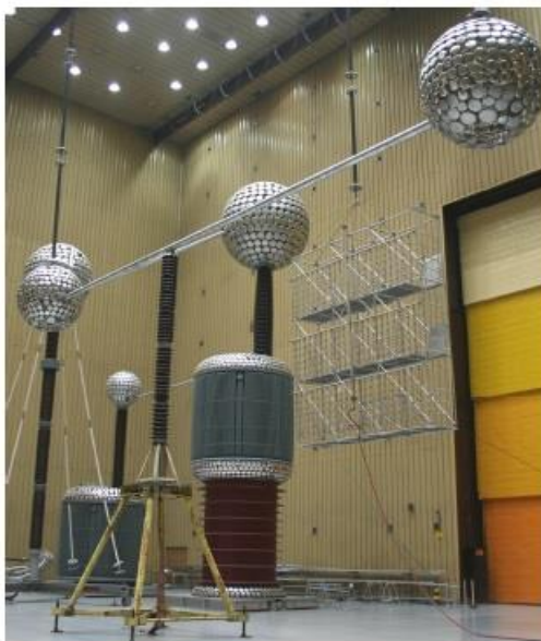
Slika 2.1. Ispitivanje dielektrične čvrstoće potpornog izolatora u vlažnim uvjetima
