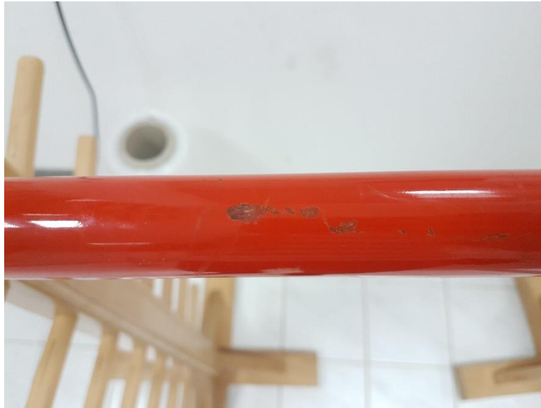
Slika 4.3. Površinsko oštećenje izolacije uzemljivačke motke
