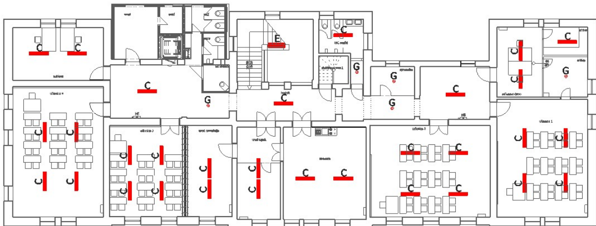
Sl. 3.4: Tlocrt prvog kata – postojeće stanje rasvjete
