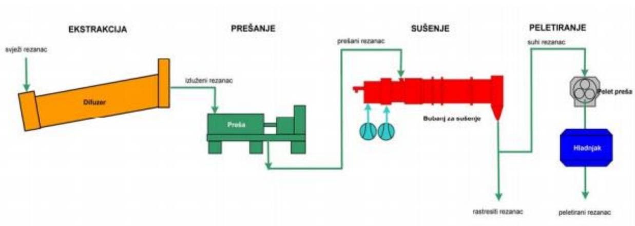
SI. 2.7. Obrada repnog rezanaca[2.]
