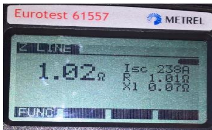
Sl. 5.4. Rezultat mjerenja impedancije petlje trofazne utičnice
