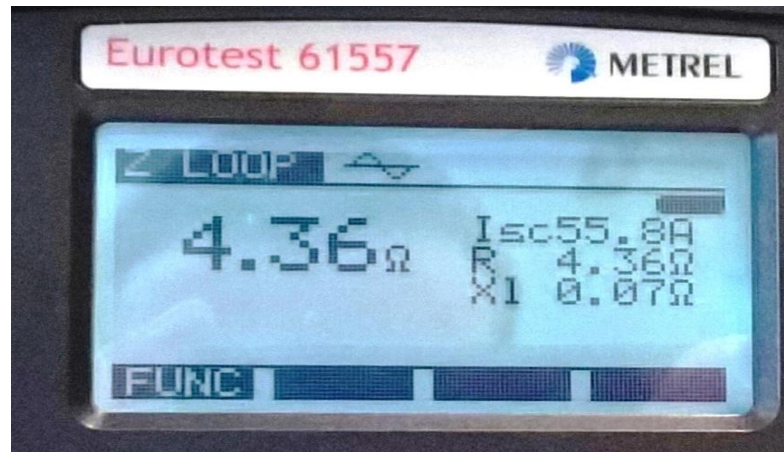
Sl. 5.11. Rezultat mjerenja otpora petlje kvara trofaznog motora (pogreška uključena)
