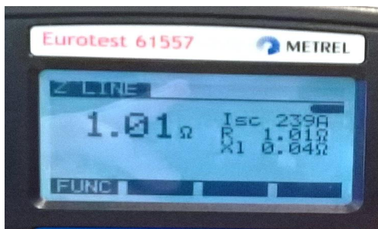
Sl. 5.7. Rezultat mjerenja impedancije petlje jednofazne utičnice 2
